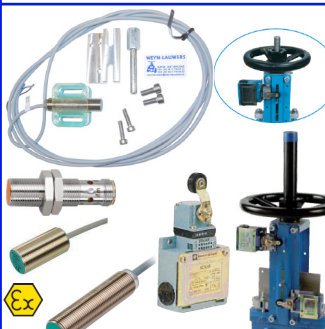
eindschakelaars mechanisch met rolstiftbediening of met naderingsschakelaars PNP NO 3-draads - 2 m kabel P&F NBB4 dia. 12 mm 10-36VDC of IFM dia. 12 mm met M12 connector of IFM ATEX 3 G/D voor zone 2 & 22
