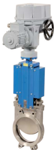
fig 3821 plaatafsluiter / flenzen PN10 huis RVS316 plaat en spindel RVS316 1-zijdig dichtend DN50 - DN400 EPDM dichting : temp. : -15°C/+110°C voorzien van elektrische motor mono-fazig of 3 x 400 VAC
