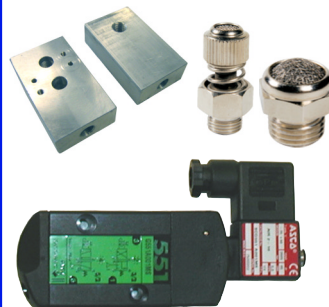
stuurventiel 5/2 monostaal gemonteerd op aluminium NAMUR montageplaat 24 VDC 24 VAC 48 VAC 230 VAC
