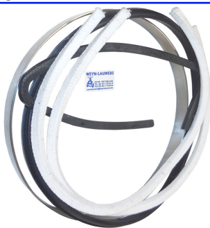
dichtingset EPDM : -20°C/+120°C (pieken tot 130°C) NBR : -20°C/+80°C VITON : -10°C/+180°C SILICONE : -30°C/+190°C TEFLON : -10°C/+180°C
