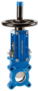
fig 380 plaatafsluiter / flenzen PN10 huis gietijzer + rilsan coating plaat en spindel RVS304 1-zijdig dichtend DN50 - DN800 NBR dichting : temp. : -10°C/+80°C bediening met handwiel, niet stijgend stijgende spindel fig 380M : metaaldichtend
