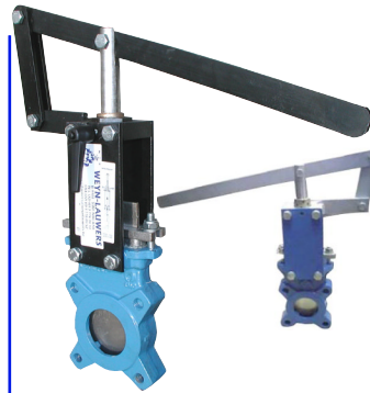
fig 383 plaatafsluiter / flenzen PN10 huis gietijzer + rilsan coating plaat en spindel RVS304 1-zijdig dichtend DN50 - DN300 NBR dichting : temp. : -10°C/+80°C hefboombediening stijgende spindel fig 383M : metaaldichtend
