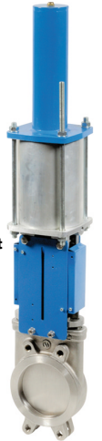
fig 3811 SR plaatafsluiter flenzen PN10 huis RVS316 plaat en spindel RVS316 1-zijdig dichtend DN50 - DN300 EPDM dichting temp. : -15°C/+110°C voorzien van enkelwerkende pneumaat
