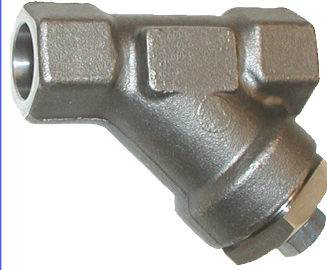
stalen Y-filter PN138 huis : staal A105 / zeef : inox fig 803 : FF 1/4" - 2" bsp fig 803NPT : FF 1/4" - 2" NPT fig 803SW : FF 1/4" - 2" SW-laseinden temp. : -20°C +440°C zeef : 0,8 mm
