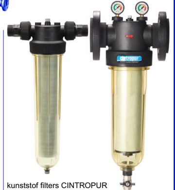
kunststof filters CINTROPUR fig 800 : MM 3/4" - 2" bsp DN65-DN80 losse flens PN10 standaard zeef : 25 micron ook verkrijgbaar : 5,10,50,100,150,300 micron temp. : max 50°C 3/4" - 2" : geleverd met koppelingen 2" - 3" : geleverd met manometers tot 5/4" max. 10 bar / groter max. 16 bar
