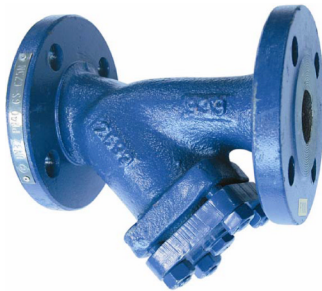
stalen Y-filter PN40 huis : staal / zeef : inox 304 fig 806 : DN15 - DN200 temp. : -20°C +400°C max. druk 40 bar inbouw lengte volgens din 3202 F1 zeef DN15 - DN50 : 1,0 mm zeef DN65 - DN80 : 1,3 mm / 1,6 mm >DN80
