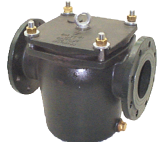
gietijzeren groffilter / recht model werkdruk : max. 2,5 - 4 bar fig 818 : DN32 - DN400 standaard vierkante gaten 8 x 8 mm snel verwijderbaar deksel huis en deksel in gietijzer oogbout in staal dichting in BNR flenzen volgens PN10
