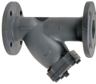
gietijzeren Y-filter PN 10/16 huis : gietijzer / zeef : inox 304 fig 805 : DN15 - DN400 temp. : -10°C +180°C max. druk 16 bar tot DN200 / 10 bar > DN200 inbouw lengte volgens din 3202 F1 zeef DN15 - DN125 : 1,1 mm zeef DN150 - DN300 : 1,5 mm / 3 mm >DN300
