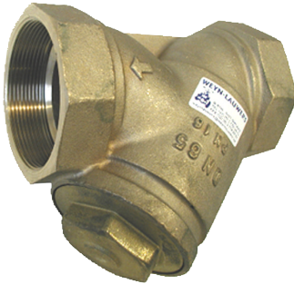
bronzen Y-filter PN16 huis : brons / zeef : inox 304 fig 801 : FF 3/8" - 4" bsp zeef : 0,4 mm tot 1" zeef : 0,5 mm boven 1" temp. : -10°C +110°C
