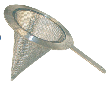
tijdelijke filters fig 849 : inox 316 of inox 304 maaswijdte op aanvraag filters worden bij de reiniging van de installatie tijdelijk tussen 2 flenzen geplaatst
