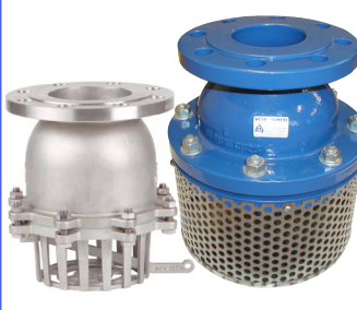
voetkleppen met filterzeef PN16 fig 795 : gietijzeren huis / stalen zeef temp. : -10°C +90°C PN16 : DN50 - DN300 fig 797 : inox 316 huis en zeef temp. : -25°C +150°C PN16 : DN50 - DN200 manueel leegloop-hendel viton zitting / telfon dichtingen
