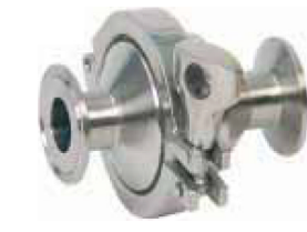
fig 280 vlinderklep RVS316L clamp/clamp 1" - 4" clamp/clamp huis : inox 316L dichting EPDM (andere op aanvraag) max. druk : 10 bar / max. temp. : +120°C fig 284 dubbelwerkend pneumatisch fig 285 enkelwerkend pneumatisch
