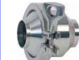
fig 281 vlinderklep RVS304 draad/draad 1" - 4" draad/draad volgens DIN 11851 huis : inox 304 dichting EPDM (andere op aanvraag) max. druk : 10 bar / max. temp. : +120°C fig 286 dubbelwerkend pneumatisch fig 287 enkelwerkend pneumatisch
