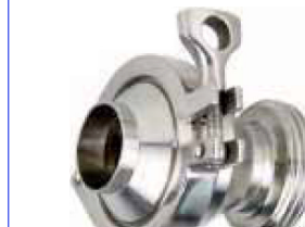
fig 282 vlinderklep RVS304 las/draad 1" - 4" las/draad volgens DIN 11851 huis : inox 304 dichting EPDM (andere op aanvraag) max. druk : 10 bar / max. temp. : +120°C fig 288 dubbelwerkend pneumatisch fig 289 enkelwerkend pneumatisch
