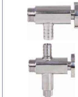
fig 888 peilglaskraan boven RVS304 fig 889 peilglaskraan onder met aflat 1/2" bsp - slangpilaar 14 mm huis : inox 304 dichting PTFE max. druk 10 bar
