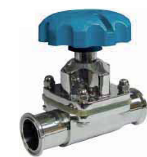
fig 292 membraanafsluiter RVS316L 1/2" - 2" clamp/clamp huis : inox 316L membraan SILICONE max. druk : 10 bar max. temp. : +95°C gepolierde uitvoering
