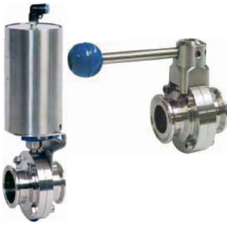
fig 280 vlinderklep RVS316L clamp/clamp 1" - 4" clamp/clamp huis : inox 316L dichting EPDM (andere op aanvraag) max. druk : 10 bar / max. temp. : +120°C fig 284 dubbelwerkend pneumatisch fig 285 enkelwerkend pneumatisch
