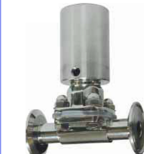
fig 293 membraanafsluiter RVS316L pneumatisch enkelwerkend NC 1/2" - 2" clamp/clamp huis : inox 316L membraan SILICONE max. druk : 10 bar / max. temp. : +95°C gepolierde uitvoering
