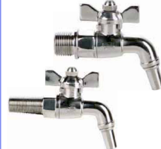
dubbel dienst kogelkranen PN16 RVS316 1/2" bsp gereduceerde doorlaat max. temp. : +100°C fig 113 korte bsp schroefdraad fig 114 lange bsp schroefdraad
