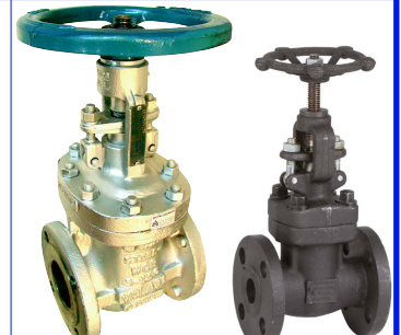
fig 375 schuifafsluiter 150 lbs huis staal ASTM A216/WCB Trim F6 flenzen volgen ANSI 150 LBS 2" - 12" temp. : -10°C/+400°C
