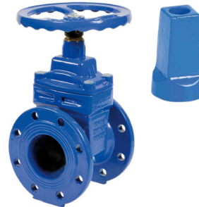
fig 334 schuifafsluiter PN16 huis nodulair gietijzer GGG50 / epoxy coating EPDM rubber beklede schuif flenzen PN10/16 DN40 - DN600 temp. : -10°C/+110°C inbouw lengte DIN 3202 F4 niet-stijgend handwiel en spindel fig 334NBR : NBR rubber beklede schuif
