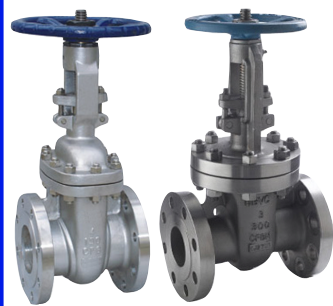
fig 354 schuifafsluiter in inox PN10 fig 355 schuifafsluiter in inox PN16 fig 356 schuifafsluiter in inox PN25 DN15 - DN600 temp. : -30°C/+400°C niet-stijgend handwiel en stijgende spindel
