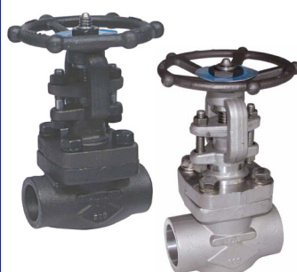
schuifafsluiters ansi 800 lbs fig 325 : staal 3/8"-2" npt schroefdraad fig 325bsp : staal 3/8"-2" bsp schroefdraad fig 326 : staal 3/8"-2" SW laseinden max. 138 bar temp. : -20°C/+440°C fig 327 : inox 316 3/8"-2" npt schroefdraad fig 328 : inox 316 3/8"-2" SW laseinden max. 138 bar temp. : -30°C/+440°C
