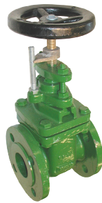
fig 330P schuifafsluiter PN10 huis gietijzer GG25 - GJL-250 bronzes dichting en spindel voorzien van standaarduiding DN40 - DN400 temp. : -10°C/+120°C inbouw lengte DIN 3202 F4 niet-stijgend handwiel en spindel
