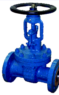
fig 370 schuifafsluiter PN16 fig 371 schuifafsluiter PN25 fig 372 schuifafsluiter PN40 fig 373 schuifafsluiter PN63 fig 374 schuifafsluiter PN100 huis staal GS-C25 DN40 - DN400 inbouw lengte DIN 3202 F5 niet-stijgend handwiel en stijgende spindel temp. : -20°C/+425°C
