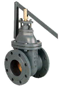
fig 331 snelsluit-schuifafsluiter PN10 huis gietijzer GG25 - GJL-250 messing afdichtingsring DN40 - DN300 temp. : -10°C/+120°C inbouw lengte DIN 3202 F4
