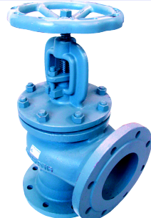
fig 454 klepafsluiter staal PN40 DN 15 - DN 200 haaks
