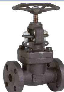
fig 495 klepafsluiter staal 150 lbs huis staal ASTM A216WCB Trim F6
