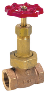
fig 411 klepafsluiter brons PN25 1/4" - 2" bsp huis : brons inox 316 klepafdichting grafiet spindelafdichting
