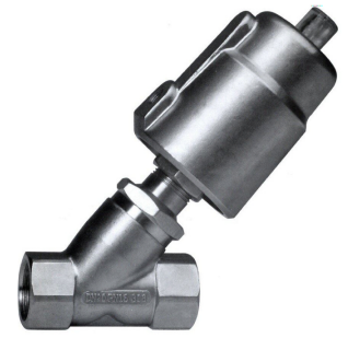
fig 5311I klepafsluiter inox pn16 pneumatisch enkelwerkend normaal gesloten 1/2" - 2" bsp
