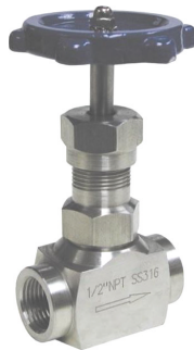
fig 523 naaldventiel inox PN210 1/4" - 2" bsp ANSI 3000 lbs huis : inox 316 teflon spindelafdichting
