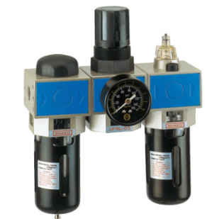
perslucht apparaat - combinaties fig 546 filter/olienevelaar/drukregelaar met manometer filter 40 micron 1/4" - 1" bsp temp. : 0°C/+50°C aluminium huis klokken in polycarbonaat / bescherming in glasvezel/nylon
