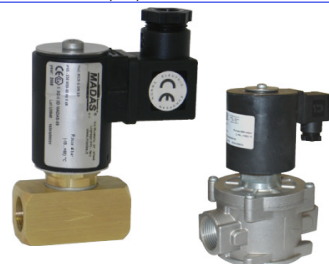
2-weg magneetventiel normaal gesloten minimum verschilddruk nodig : 0,5 bar fig 629 : (SPU225) FF 3/8" - 2" bsp huis : inox / viton dichting temp. : -10°C +90°C 24 - 48 - 230 VAC / 12 - 24 VDC fig 630 : (SPU225-X) FF 1/2" - 3/4" bsp Ex-uitvoering ATEX EEx m II 2G/D T4 voor zones 1, 21, 2 en 22
