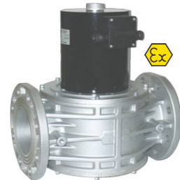
2-weg magneetventiel normaal gesloten voor gasen : aardgas-propaan-methaan-lpg fig 633 : (EVP) DN65-DN80-DN100 flenzen max 360 mbar huis : aluminium temp. : -20°C +60°C 24 - 230 VAC ATEX EEx II 3G/D voor zones 2 en 22
