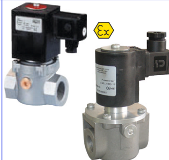
2-weg magneetventiel normaal gesloten voor gasen : aardgas-propaan-methaan-lpg fig 631 : (EVP) 1/2"-2" bsp -max 360 mbar huis : aluminium temp. : -20°C +60°C 24 - 230 VAC ATEX EEx II 3G/D voor zones 2 en 22 fig 632 : (EV-6) 1/2"-2" bsp - 6 bar
