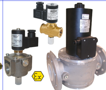
2-weg magneetventiel normaal gesloten met manuele reset voor gasen : aardgas-propaan-methaan-lpg 24 - 230 VAC ATEX EEx II 3G/D voor zones 2 en 22 gasdruk max. 500 mbar of 6 bar naar keuze fig 634 : (M14) 1/2"-1" bsp : huis messing : (M14) 5/4 - 2" bsp : huis aluminium fig 635 : (M16) DN65-DN300 : huis aluminium
