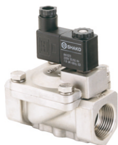
2-weg magneetventiel normaal gesloten minimum verschilddruk nodig : 0,5 bar fig 629 : (SPU225) FF 3/8" - 2" bsp huis : inox / viton dichting temp. : -10°C +90°C 24 - 48 - 230 VAC / 12 - 24 VDC fig 630 : (SPU225-X) FF 1/2" - 3/4" bsp Ex-uitvoering ATEX EEx m II 2G/D T4 voor zones 1, 21, 2 en 22
