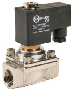
2-weg magneetventiel normaal gesloten directwerkend = geen verschilddruk nodig fig 627 : (SPU220) FF 1/2" - 3/4" bsp huis : inox / viton dichting temp. : -10°C +90°C 24 - 48 - 230 VAC / 12 - 24 VDC fig 628 : (SPU220-X) FF 1/2" - 3/4" bsp Ex-uitvoering ATEX EEx m II 2G/D T4 voor zones 1, 21, 2 en 22
