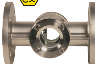
fig 867 inox kijkglas met flapper PN16 DN15 - DN150 huis : inox 316 (CF8M) flapper : inox 316 (CF8M) dubbel getemperd glas temp. : -20°C +180°C max. druk 16 bar flenzen volgens PN16 fig 867.150 met ansi 150 lbs flenzen
