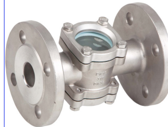
fig 887 inox kijkglas PN16 DN15 - DN100 huis : inox 316 (CF8M) dubbel kijkglas max. druk 16 bar bij +50°C max. temp. +200°C bij 10 bar flenzen volgens PN16
