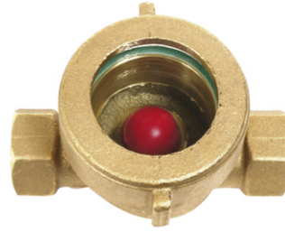
fig 861 kijkglas met kunststof bal 1/2" - 1" bsp / huis in brons CC491K enkel getemperd glas temp. : +5°C +80°C max. druk 16 bar
