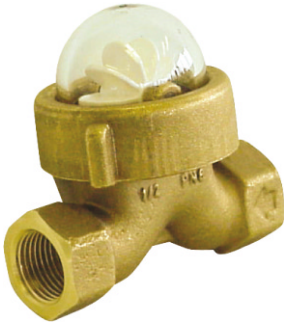
fig 859 messing kijkglas met rotor 1/2" - bsp huis : messing CB754S rotor in kunststof / bulp in polycarbonaat temp. : +10°C +70°C max. druk 6 bar inbouw lengte 80 mm
