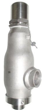
fig 1216 inox veiligheidsklep 1/2" tot 2" bsp of npt huis : inox A351 CF3M / gesloten kap viton- / teflon- of metaaldichtende zitting druk : PN40 tot PN400 fig 1216C : met clamp-aansluiting fig 1216B : flenzen PN10/40 ansi 150/300 lbs
