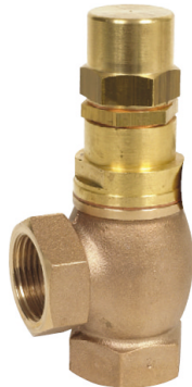
fig 901 bronzen overstopventiel 3/8" - 2" bsp huis : brons CC491K / gesloten kap teflon zitting max. druk : 20 bar / temp. : -40°C/+180°C insteldruk : 0,5 - 2,5 bar / 2,0 - 12 bar 12 - 20 bar
