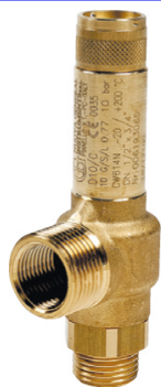
fig 903 messing veiligheidsklep 1/4" - 2" bsp MM huis : messing CW614N viton zitting temp. : -20°C/+160°C insteldruk : 0,5 - 12 bar (elke 0,5 bar) bijzonder geschikt voor vloeistoffen
