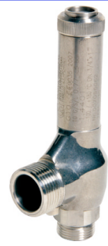
fig 905 inox veiligheidsklep 3/8" - 2" bsp MM huis : inox 316 teflon zitting temp. : -10°C/+200°C insteldruk : 0,5 - 12 bar (elke 0,5 bar)
