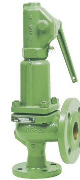
fig 1402 geflensd veiligheidsventiel PN40 DN20 tot DN150 huis : nod.gietijzer GGG40 / met kleplicher gesloten kap / inox zitting temp. : -10°C +350°C min. afsteldruk 0,5 bar bureau veritas marine/offshore gekeurd
