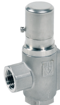
fig 902 inox overstopventiel 3/8" - 5/4" bsp huis : inox 316 (CF8M) / gesloten kap viton zitting max. druk : 30 bar / temp. : -10°C/+200°C insteldruk : 1,2 - 3,0 bar 2 - 12 bar
