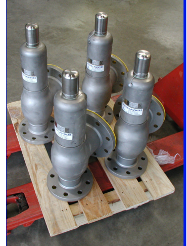
fig 905 inox veiligheidsklep 3/8" - 2" bsp MM huis : inox 316 teflon zitting temp. : -10°C/+200°C insteldruk : 0,5 - 12 bar (elke 0,5 bar)
