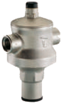
fig 920 drukreduceerventiel RINOX 1/2" - 4" bsp huis : messing vernikkeld / zitting : inox 304 O-ring : NBR / membraan : EPDM / veer staal temp. : max. +80°C max. voordruk P1 : 25 bar instelbaar tot 1" : 0,8 - 5,5 bar instelbaar >1" : 0,8 - 7,0 bar geschikt voor lucht en niet-corrosieve vloeist.
