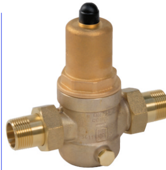
fig 922 bronzen drukreduceerventiel 1/2" - 2" bsp MM met koppelingen huis : brons CC491K voorzien van inox filterzeef temp. : max. +95°C max. voordruk P1 : 25 bar instelbaar : 1,0 - 7,0 bar geleverd met manometer geschikt voor lucht en niet-corrosieve vloeist.
