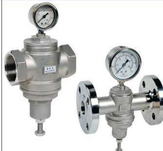
fig 931 inox stoomdrukreduceerventiel 1/2" - 1" bsp type PRV-S voorzien van manometer diam. 63 mm huis : inox 316 (CF8M) dichtingen in viton/teflon druk P2 : max. 80 % van druk P1 temp. : max. +192°C / max. druk P1 : 12 bar instelbaar : 1,0 - 6 bar / 4,0 - 10 bar fig 932 idem met flenzen PN16
