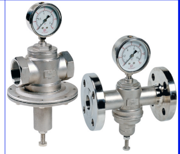
fig 925 inox drukreduceerventiel LPRV PN10 1/2" - 2" bsp huis : inox 316 (CF8M) voorzien van manometer dichtingen in viton temp. : -15°C +80°C max. druk P1 : 16 bar instelbaar : 0,2- 1,5 bar fig 927 idem voorzien van flenzen PN16
