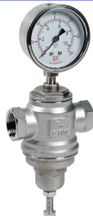
fig 924 inox drukreduceerventiel PRV PN16 1/2" - 2" bsp huis : inox 316 (CF8M) voorzien van manometer dichtingen in viton temp. : -15°C +100°C max. druk P1 : 16 bar instelbaar : 1,0- 6 bar / 4,0- 10 bar / 8- 13 bar
