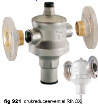
fig 921 drukreduceerventiel RINOX DN25 - DN100 flens PN16 huis : messing vernikkeld / zitting : inox 304 O-ring : NBR / membraan : EPDM / veer staal temp. : max. +80°C max. voordruk P1 : 25 bar instelbaar tot 1" : 0,8 - 5,5 bar instelbaar >1" : 0,8 - 7,0 bar draadflenzen niet gemonteerd geleverd
