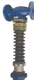
fig 934 stoomdrukreduceerventiel DRP40 DN40 - DN100 flens PN40 huis : staal / balg : inox temp. : max. +215°C max. druk P1 : 20 bar max. verschildruk delta P : 10 bar instelbaar : 0,2 - 1,5 bar / 1 - 4 bar 1,2 - 6,0 bar / 1 - 10 bar 8,0 - 13 bar
