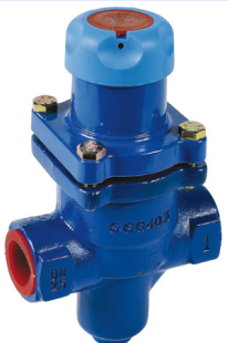
fig 930 stoomdrukreduceerventiel PN25 1/2" - 1" bsp type BDV25 geschikt voor stoom - lucht - gassen huis : nod. gietijzer GGG40.3 inox binnenwerk ingebouwde filter temp. : max. +210°C max. druk P1 : 17 bar instelbaar : 0,14 - 1,7 / 1,4 - 4,0 / 3,5 - 8,6 bar
