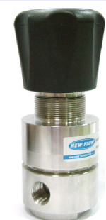
fig 935 inox drukreduceerventiel PRU PN240 / 3500psi 1/4" - 1/2" npt huis : inox 316 temp. : -40°C +175°C voorzien van manometers type PRU-100 1/4"npt instelbaar : 0,07-3,4 bar/ 0,2-17 bar/ 0,35-34 bar type PRU-200 1/2"npt instelbaar : 0,2-17 bar / 0,35-34 bar
