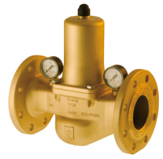
fig 923 bronzen drukreduceerventiel PN16 DN20 - DN80 flens PN16 huis : brons CC491K voorzien van inox filterzeef temp. : max. +95°C max. voordruk P1 : 25 bar instelbaar : 1,0 - 7,0 bar geleverd met manometer geschikt voor lucht en niet-corrosieve vloeist.
