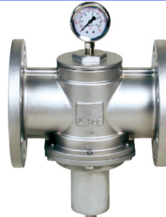
fig 926 inox drukreduceerventiel PRV DN15 - DN100 flens PN16 huis : inox 316 (CF8M) voorzien van manometer dichtingen in viton temp. : -15°C +100°C max. druk P1 : 16 bar instelbaar : 1,0- 6 bar / 4,0- 10 bar / 8- 13 bar
