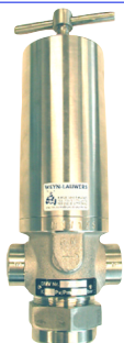
fig 933 inox drukreduceerventiel 3/8" - 2" bsp huis : inox 316TI (1.4301 / 1.4571) inox binnenwerk temp. : -50°C +150°C mogelijk druk : tot 200 bar mogelijk instelbaar : vanaf 0,05 - 200 bar mogelijk beschikbare dichtingen : NBR / FPM / EPDM PTFE / PA6
