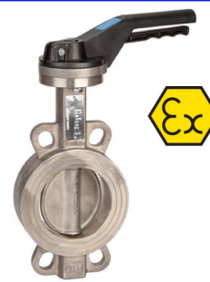
fig 231 wafer type PN10/16 ansi 150lbs voor rookgassen tot 350°C sluit niet 100 % af vlinder en as RVS316 DN32 - DN200 fig 231 : huis RVS316 voorzien van iso 5211 topflens
