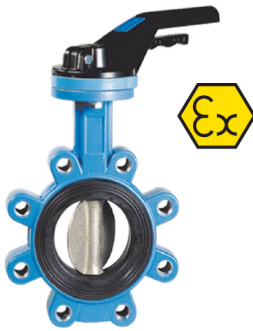
fig 265 LUG type PN10/16 huis nodulair gietijzer + epoxy coating vlinder en as RVS316 dichting EPDM DN40 - DN400 temp. : -20°C/+120°C voorzien van iso 5211 topflens wormwielkast op aanvraag verwisselbare dichting
