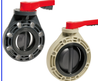
fig 241/242/243/244 wafer type PN10 fig 241 : PVC huis en vlinder / EPDM dichting fig 242 : PVC huis en vlinder / VITON dichting fig 243 : PP huis en vlinder / EPDM dichting fig 244 : PP huis en vlinder / VITON dichting PVC max 60°C / PP max 80°C DN 40 - DN300 ABS hendel
