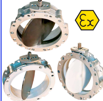
silobouw / poedertransport huis : aluminium stofdicht tot max. 0,2 bar fig 237 : flens/sleeve dn100 - dn400 fig 238 : flens/flens dn100 - dn400 vlinder : nodulair gietijzer fig 239 : flens/flens dn100 - dn400 vlinder : RVS
