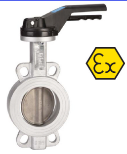
fig 233 wafer type PN10/16 ansi 150lbs voor rookgassen tot 350°C sluit niet 100 % af vlinder en as RVS316 tot dn100 / > in GGG50 DN32 - DN200 fig 233 : huis staal A213WCB voorzien van iso 5211 topflens
