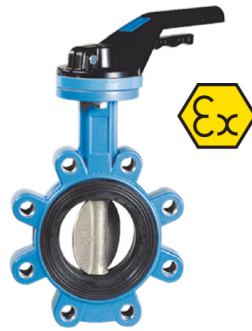
fig 215V LUG type PN10/16 huis nodulair gietijzer + epoxy coating vlinder en as RVS316 dichting VITON DN40 - DN2500 temp. : -10°C/+180°C voorzien van iso 5211 topflens wormwielkast op aanvraag verwisselbare dichting
