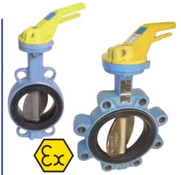
fig 205B gas wafer PN10/16 ansi 150 lbs fig 255B gas lug type PN10/16 huis nodulair gietijzer + epoxy coating dichting NBR / vlinder nodulair gietijzer DN32 - DN200 temp. : -20°C/+80°C voorzien van iso 5211 topflens wormwielkast op aanvraag verwisselbare dichting
