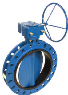
dubbelflens PN16 vlinder concentrisch geplaatst huis : nodulair gietijzer GGG dichting EPDM DN150 - DN1400 temp. : -10°C/+90°C voorzien van wormwielkast fig 245 : vlinder nodulair gietijzer fig 246 : vlinder RVS316
