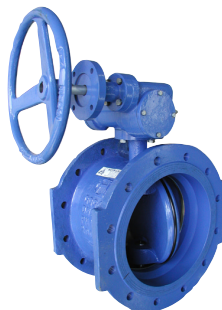
dubbelflens PN10 / 16 / 25 vlinder dubbel excentrisch geplaatst huis en vlinder : nodulair gietijzer GGG dichting EPDM DN150 - DN1600 temp. : -10°C/+90°C fig 247 : PN10 fig 248 : PN16 fig 249 : PN25
