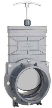
fig 389 plaatafsluiter in PVC 80-110-160 mm huis en plaat in PVC-U EPDM dichting bediening met hendel / aansluiting lijmeinden max. 6 bar / 0°C/+60°C
