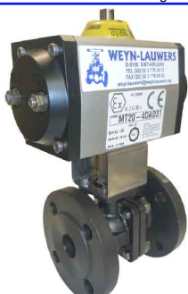
staal PN40/16 - ALUMINIUM pneumaat 2-delig - volle doorlaat MT : dubbelwerkende pneumaat MST : enkelwerkende pneumaat DN15 - DN50 : PN40 DN65 - DN200 : PN16 fig 164 MT : DN15 - DN200 geflensd fig 164 MST : DN15 - DN200 geflensd
