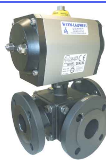
3-weg - ALUMINIUM pneumaat volle doorlaat - PN16 MT : dubbelwerkende pneumaat MST : enkelwerkende pneumaat fig 191L MT/MST : DN25 - DN150 staal fig 191T MT/MST : DN25 - DN150 staal fig 192L MT/MST : DN15 - DN150 RVS fig 192T MT/MST : DN15 - DN150 RVS
