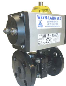
nodulair gietijzer - ALUMINIUM pneumaat volle doorlaat - PN16 MT : dubbelwerkende pneumaat MST : enkelwerkende pneumaat fig 151 MT : DN15 - DN200 geflensd fig 151 MST : DN15 - DN200 geflensd
