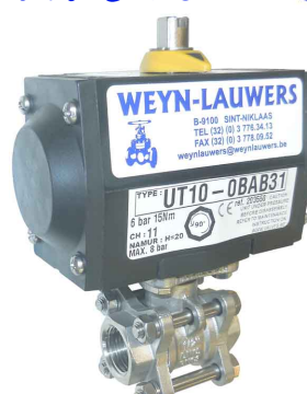
RVS - KUNSTSTOF pneumaat 3-delig - volle doorlaat - bsp draadeinden UT : dubbelwerkende pneumaat UTS : enkelwerkende pneumaat
