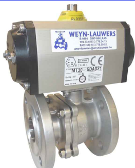
RVS PN40/16 - ALUMINIUM pneumaat 2-delig - volle doorlaat MT : dubbelwerkende pneumaat MST : enkelwerkende pneumaat DN15 - DN50 : PN40 DN65 - DN200 : PN16 fig 175 MT : DN15 - DN200 geflensd fig 175 MST : DN15 - DN200 geflensd
