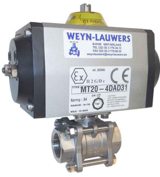
RVS - ALUMINIUM pneumaat 3-delig - volle doorlaat - bsp draadeinden MT : dubbelwerkende pneumaat MST : enkelwerkende pneumaat
