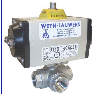
RVS - ALUMINIUM pneumaat 3-weg- gereduceerde doorlaat - bsp MT : dubbelwerkende pneumaat MST : enkelwerkende pneumaat fig 186 MT : L-boring 1/4"- 2 1/2"bsp fig 186 MST : L-boring 1/4"- 2 1/2"bsp fig 187 MT : T-boring 1/4"- 2 1/2"bsp fig 187 MST : T-boring 1/4"- 2 1/2"bsp
