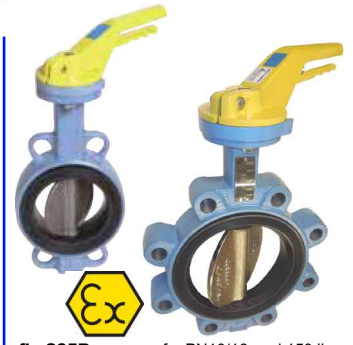
fig 205B gas wafer PN10/16 ANSI 150 lbs fig 255B gas lug type PN10/16 huis nodulair gietijzer + epoxy coating dichting NBR / vlinder nodulair gietijzer DN32 - DN200 temp. : -20°C/+80°C voorzien van iso 5211 topflens wormwielkast op aanvraag verwisselbare dichting
