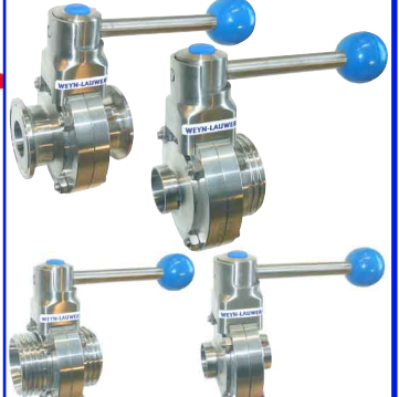
sanitaire vlinderkleppen 1" - 4" huis en vlinder RVS - dichting EPDM fig 280 : clamp/clamp fig 281 : draad/draad DIN 11851 fig 282 : las/draad DIN 11851 fig 283 : las/las
