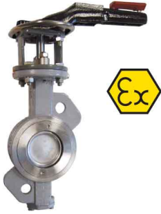
fig 235 wafer type PN25 dubbel excentrische uitvoering vlinder en as RVS316 dichting PTFE + 15 % grafiet DN50 - DN400 temp. : -30°C/+210°C voorzien van iso 5211 topflens wormwielkast op aanvraag fig 234 : huis staal / fig 235 : huis RVS316
