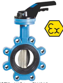
fig 265V LUG type PN10/16 huis nodulair gietijzer + epoxy coating vlinder en as RVS316 dichting VITON DN40 - DN2500 temp. : -10°C/+180°C voorzien van iso 5211 topflens wormwielkast op aanvraag verwisselbare dichting
