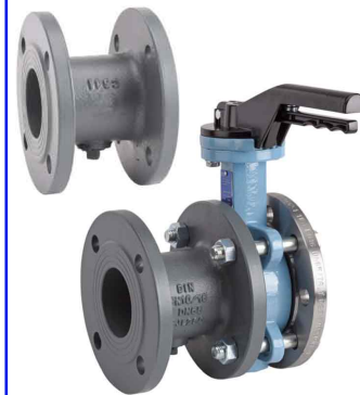
uitbouwstuk PN10/16 gietijzer om schuifafsluiter of kogelkraan (EN 558 / 14) te vervangen door een vlinderklep DN40 - DN200
