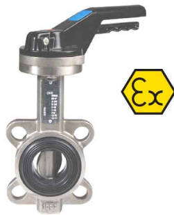
fig 228 wafer PN10/16 ANSI 150 lbs huis staal vlinder en as RVS316 dichting EPDM DN32 - DN300 temp. : -20°C/+120°C voorzien van iso 5211 topflens wormwielkast op aanvraag verwisselbare dichting
