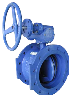
dubbelflens PN10 / 16 / 25 vlinder dubbel excentrisch geplaatst huis en vlinder : nodulair gietijzer GGG dichting EPDM DN150 - DN1600 temp. : -10°C/+90°C fig 247 : PN10 fig 248 : PN16 fig 249 : PN25
