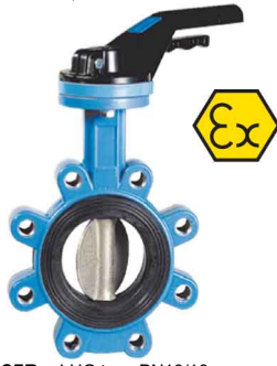
fig 265B LUG type PN10/16 huis nodulair gietijzer + epoxy coating vlinder en as RVS316 dichting NBR DN40 - DN250 temp. : -20°C/+90°C voorzien van iso 5211 topflens wormwielkast op aanvraag verwisselbare dichting
