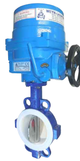
wafer - ALUMINIUM motor RVS 316 vlinder/ PTFE dichting / PN10/16 SA : 230VAC 24VDC/AC 12VDC NA : 230VAC 3x400VAC
