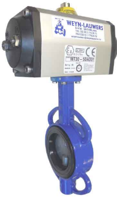
wafer - ALUMINIUM pneumaat RVS 316 vlinder/EPDM dichting / PN10/16 MT : dubbelwerkende pneumaat MTS : enkelwerkende pneumaat
