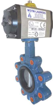
LUG - ALUMINIUM pneumaat RVS 316 vlinder/EPDM dichting / PN10/16 MT : dubbelwerkende pneumaat MTS : enkelwerkende pneumaat
