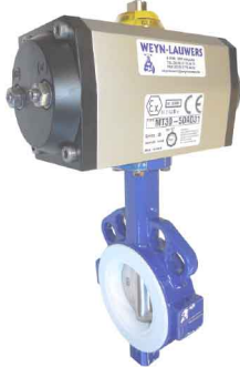
wafer - ALUMINIUM pneumaat RVS 316 vlinder/ PTFE dichting / PN10/16 MT : dubbelwerkende pneumaat MTS : enkelwerkende pneumaat
