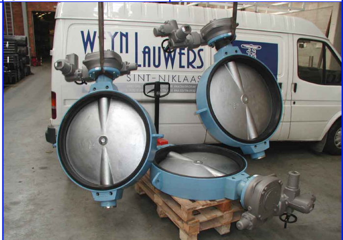
wafer - ALUMINIUM pneumaat RVS 316 vlinder/ PTFE dichting / PN10/16 MT : dubbelwerkende pneumaat Ex dmb IIC ATEX II G fig 229MT YT-100R : DN50 - DN200
