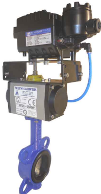
wafer - ALUMINIUM pneumaat RVS 316 vlinder/EPDM dichting / PN10/16 MT : dubbelwerkende pneumaat Ex dmb IIC ATEX II G fig 210MT YT-100R : DN50 - DN600
