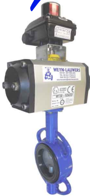
wafer - ALUMINIUM pneumaat RVS 316 vlinder/EPDM dichting / PN10/16 MT : dubbelwerkende pneumaat MTS : enkelwerkende pneumaat BE45 box met 2 mech. eindschakelaars
