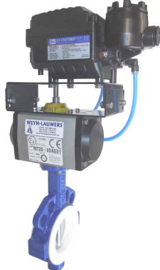
wafer - ALUMINIUM pneumaat RVS 316 vlinder/ PTFE dichting / PN10/16 MT : dubbelwerkende pneumaat Ex dmb IIC ATEX II G fig 229MT YT-100R : DN50 - DN200
