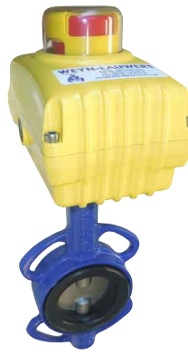
wafer - ALUMINIUM motor RVS 316 vlinder/EPDM dichting / PN10/16 SA : 230VAC 24VDC/AC 12VDC NA : 230VAC 3x400VAC
