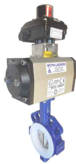
wafer - ALUMINIUM pneumaat RVS 316 vlinder/ PTFE dichting / PN10/16 MT : dubbelwerkende pneumaat MTS : enkelwerkende pneumaat BE45 box met 2 mech. eindschakelaars
