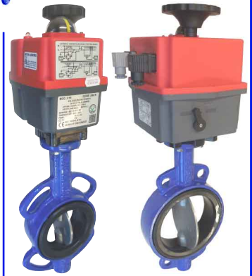
wafer - KUNSTSTOF motor RVS 316 vlinder/EPDM dichting / PN10/16 S-serie : 24V tot 240V AC/DC H- en L-serie : 85-240VAC/DC / 24VAC/DC
