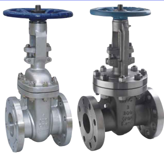
fig 354 schuifafsluiter in inox PN10 fig 355 schuifafsluiter in inox PN16 fig 356 schuifafsluiter in inox PN25 DN15 - DN600 temp. : -30°C/+400°C niet-stijgend handwiel en stijgende spindel
