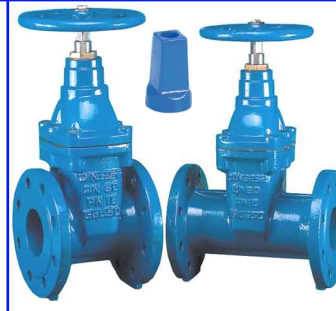
fig 334 schuifafsluiter PN16 of PN10 huis nodulair gietijzer GGG50 / epoxy coating EPDM rubber beklede schuif flenzen PN10/16 DN40 - DN600 temp. : -10°C/+110°C fig 334 inbouw lengte EN 558/14 (DIN 3202 F4) fig 335 inbouw lengte EN558/15(DIN3202 F5) niet-stijgend handwiel en spindel fig 334NBR : NBR rubber beklede schuif
