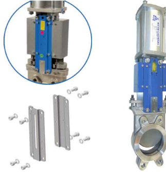
fig 3811 plaatafsluiter / flenzen PN10 huis RVS316 plaat en spindel RVS316 1-zijdig dichtend DN50 - DN400 EPDM dichting : temp. : -15°C/+110°C voorzien van dubbelwerkende pneumaat optie : RVS frame- en beschermplaten
