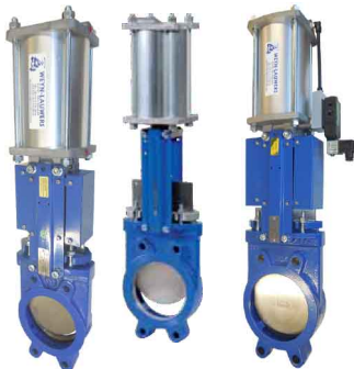
fig 381 plaatafsluiter / flenzen PN10 huis gietijzer + rilsan coating plaat en spindel RVS304 1-zijdig dichtend DN50 - DN600 NBR dichting : temp. : -10°C/+80°C voorzien van dubbelwerkende pneumaat fig 381M : metaaldichtend
