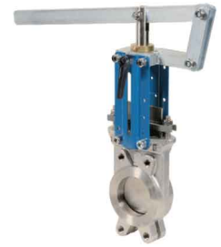
fig 3831 plaatafsluiter / flenzen PN10 huis RVS316 plaat en spindel RVS316 1-zijdig dichtend DN50 - DN300 EPDM dichting : temp. : -15°C/+110°C hefboombediening stijgende spindel
