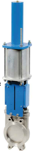
fig 381 SR plaatafsluiter flenzen PN10 huis RVS316 plaat en spindel RVS316 1-zijdig dichtend DN50 - DN300 EPDM dichting temp. : -15°C/+110°C voorzien van enkelwerkende pneumaat
