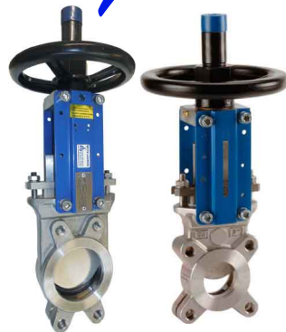
fig 3801 plaatafsluiter / flenzen PN10 huis RVS316 plaat en spindel RVS316 1-zijdig dichtend DN50 - DN400 EPDM dichting : temp. : -15°C/+110°C bediening met handwiel, niet stijgend stijgende spindel
