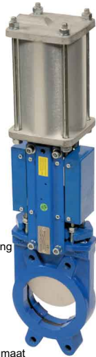
fig 387 BS plaatafsluiter PN10 huis RVS316 plaat en spindel RVS304 2-zijdig dichtend DN50 - DN400 NBR dichting temp. : -10°C/+80°C zonder bediening
