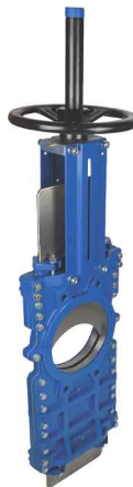
fig 385 plaatafsluiter flenzen PN10 huis gietijzer + rilsan coating plaat en spindel RVS304 2-zijdig dichtend DN50 - DN600 doorschuivende plaat NBR dichting temp. : -10°C/+80°C voorzien van bediening met handwiel, niet stijgend
