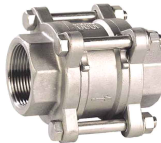
RVS terugslagklep PN40 met RVS 316 veer fig 784T : FF 1/4" - 4" bsp huis RVS 316 metaal/metaal dichtend RVS 316 teflon huisafdichtingen fig 784NPT : NPT draadeinden fig 784BW : BW laseinden fig 784SW : SW laseinden
