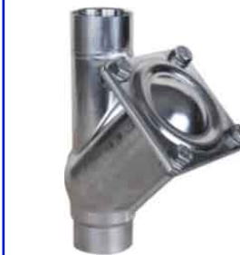
RVS balkeerklep PN16 huis RVS 316 fig 773 : FF 5/4" - 2" bsp bal aluminium met viton coating temp. : -30°C +180°C
