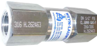
RVS terugslagklep PN 400 RVS 316 huis, kogel en dichting fig 788 : FF 1/4" - 1" bsp fig 789 : FF 1/4" - 1" npt temp. : -30°C +180°C max. druk 400 bar
