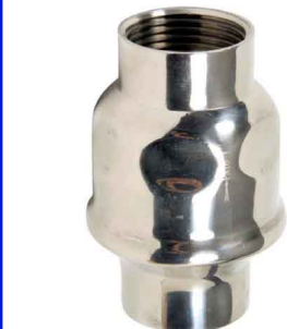
RVS terugslagklep PN16 met RVS veer RVS klep en viton klepzitting temp. : -10°C +150°C FF 1/4" - 4" bsp fig 713 : in RVS 304 fig 714 : in RVS 316
