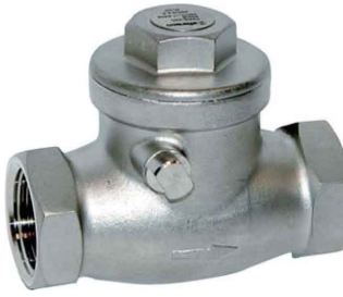
RVS terugslagklep PN16 met flapper / zonder veer fig 712 : FF 1/2" - 2" bsp teflon kleptring temp. : -30°C +180°C max. 16 bar bij 120°C max. 10 bar bij 180°C
