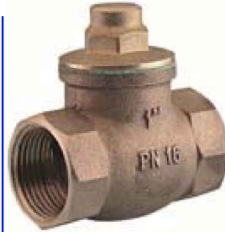
bronzen terugslagklep PN16 met RVS veer teflon klepafdichtingsring temp. : -10°C +200°C fig 716 : FF 3/8" - 2" bsp
