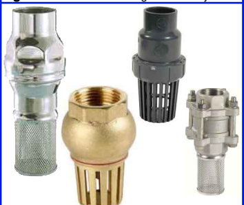
voetkleppen met filterzeef fig 791 : messing/NBR : FF 1/2" - 4" bsp temp. : 0°C +90°C fig 792 : RVS/RVS : FF 3/8" - 4" bsp veer 3-delig huis / temp. : -30°C +200°C fig 793 : RVS/viton : FF 1/2" - 4" bsp veer temp. : -25°C +150°C fig 732 : PVC/EPDM : 20-63 mm lijmeinden veer temp. : 0°C +60°C
