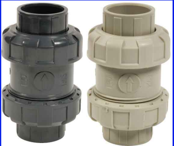
PVC / PP veerterugslagkleppen PN10 PVC uitvoering : max. +60°C / PP max. +80°C fig 730 : PVC/EPDM dichtingen / 1/2"-2" bsp fig 731 : PVC/EPDM dichtingen / 20-63 lijm fig 733 : PVC/VITON dichtingen / 1/2"-2" bsp fig 734 : PVC/VITON dichtingen / 20-63 lijm fig 740 : PP/EPDM dichtingen / 1/2"-2" bsp fig 741 : PP/EPDM dichtingen / 20-63 lijm fig 743 : PP/VITON dichtingen / 1/2"-2" bsp fig 744 : PP/VITON dichtingen / 20-63 lijm
