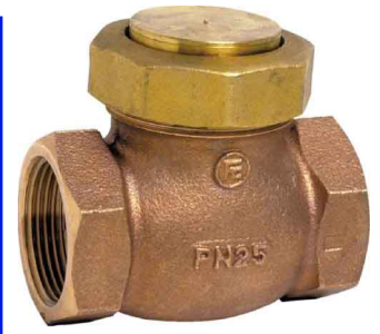
bronzen terugslagklep PN25 met RVS veer RVS klep en klepzitting temp. : -10°C +200°C fig 717 : FF 1/4" - 2" bsp
