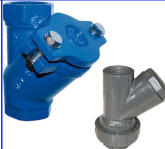
nodulair gietijzeren balkeerklep PN10 huis : GGG40 fig 770 FF 1" - 3" bsp bal NBR rubber tot 6/4" bal aluminium met NBR coating > 6/4" temp. : -30°C +80°C
