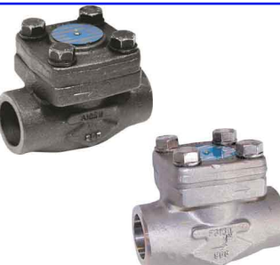
terugslagkleppen ANSI 800 lbs piston type fig 721.1 : staal 3/8" - 2" npt fig 721.1bsp : staal 3/8" - 2" bsp fig 724.1 : staal 3/8" - 2" SW-laseinden bal type fig 722.1 : staal 3/8" - 2" npt fig 725.1 : staal 3/8" - 2" SW-laseinden fig 721.3 : RVS 316 / 3/8" - 2" npt fig 725.3 : RVS 316 / 3/8" - 2" SW-laseinden
