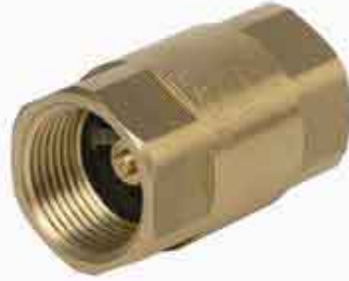
messing terugslagklep PN25/12 met veer fig 704 : FF 3/8" - 4" bsp NBR rubber afdichting temp. : -10°C +90°C RVS veer fig 704NPT : met NPT schroefdraad fig 704CHROOM : verchroomd
