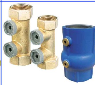
BELGAQUA gekeurde terugslagklep PN10 EA keerkleppen pollustop : FF 1/2" - 2" bsp in messing FF 2 1/2" - 3" bsp in gietijzer messing : temp. : max +80°C gietijzer : temp. : max +100°C 2 afgeplugde boringen veer in RVS
