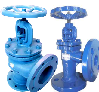
fig 454 klepafsluiter staal PN40 DN 15 - DN 200 haaks huis : staal GS-C25 RVS klepafdichting en spindel grafiet spindelafdichting stijgende spindel en handwiel temp. : -20°C/+400°C flenzen volgens PN40 fig 454BR haaks PN40 bronsen klep
