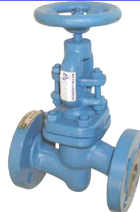
fig 456 klepafsluiter staal PN63 DN 15 - DN 200 huis : staal GS-C25 RVS klepafdichting en spindel grafiet spindelafdichting stijgende spindel en handwiel temp. : -20°C/+400°C
