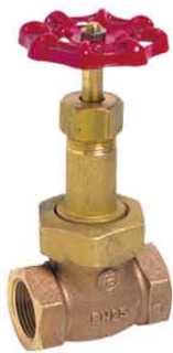
fig 411 klepafsluiter brons PN25 1/4" - 2" bsp huis : brons RVS 316 klepafdichting grafiet spindelafdichting temp. : -10°C/+180°C
