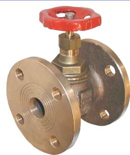
fig 430 klepafsluiter brons pn16 DN 15 - DN 50 huis : brons PTFE klepafdichting temp. : -10°C/+180°C fig 430R : voorzien van regelconus
