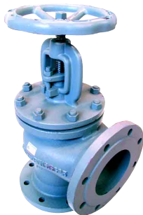
fig 434 klepafsluiter gietijzer PN16 DN 15 - DN 200 haaks huis : gietijzer RVS klepafdichting en spindel grafiet spindelafdichting stijgende spindel en handwiel temp. : -10°C/+300°C
