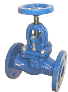
fig 490 klepafsluiter/terugslagklep PN16 DN 15 - DN 300 huis : gietijzer bronsen klepafdichting en zitting temp. : -10°C/+225°C inbouw lengte volgens din 3202 F1
