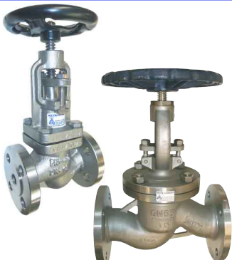
fig 460 klepafsluiter in inox PN16 fig 461 klepafsluiter in inox PN40 DN15 - DN300 huis : RVS CF8M (316) temp. : -30°C/+300°C stijgende spindel en handwiel
