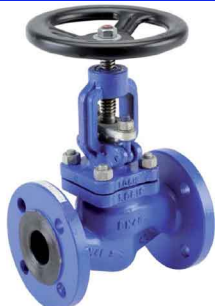
fig 455 klepafsluiter staal PN40 DN 15 - DN 200 huis : staal A216WCB RVS klepafdichting en spindel grafiet spindelafdichting stijgende spindel en handwiel temp. : -20°C/+400°C flenzen volgens PN40 inbouw lengte volgens din 3202 F1
