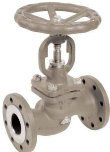
fig 433 klepafsluiter gietijzer PN16 DN 15 - DN 200 huis : gietijzer RVS klepafdichting en spindel grafiet spindelafdichting stijgende spindel en handwiel temp. : -10°C/+300°C
