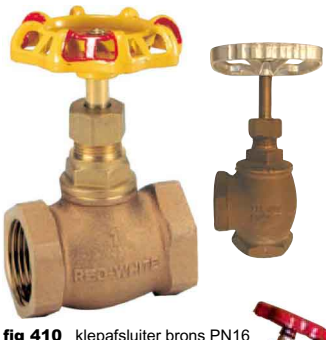
fig 410 klepafsluiter brons PN16 1/2" - 2" bsp huis : brons PTFE klepafdichting grafiet spindelafdichting temp. : -10°C/+180°C
