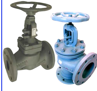
fig 433BR klepafsluiter gietijzer PN16 DN 15 - DN 200 huis : gietijzer bronsen klepafdichting en zitting grafiet spindelafdichting stijgende spindel en handwiel temp. : -10°C/+200°C
