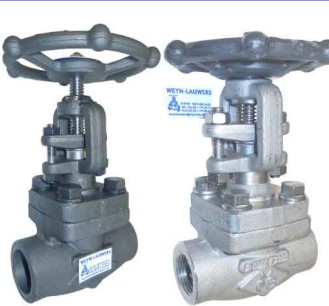
klepafsluiters ansi 800 lbs fig 425 : staal 3/8"-2" npt schroefdraad fig 425bsp : staal 3/8"-2" bsp schroefdraad fig 426 : staal 3/8"-2" SW laseinden max. 138 bar temp. : -20°C/+440°C fig 427 : RVS 316 3/8"-2" npt schroefdraad fig 428 : RVS 316 3/8"-2" SW laseinden max. 138 bar temp. : -30°C/+440°C
