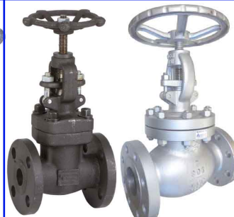
fig 495 klepafsluiter staal 150 lbs huis staal ASTM A216WCB Trim F6 flenzen volgens ANSI 150 lbs 1/2" - 12" temp. : -20°C/+400°C fig 496 klepafsluiter staal 300 lbs fig 497 klepafsluiter staal 600 lbs
