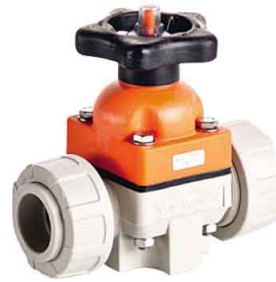
fig 502 membranaafsluiter 20 mm tot 110 mm lijmeinden fig 502bsp membranaafsluiter 1/2" - 4" bsp temp. : +0°C +60°C max. druk 10 bar huis : PVC-U membraan en dichtingen : EPDM
