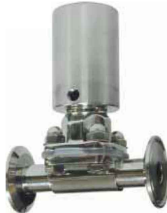
fig 293 membranaafsluiter pneumatisch clampaansluiting 1/2" tot 2" huis : RVS316L gepolijst membraan : silicone temp. : +10°C +95°C max. druk 10 bar pneumatisch normaal gesloten
