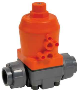
membranaafsluiter pneumatisch 20 mm tot 40 mm lijmeinden fig 510 normaal gesloten fig 512 normaal open temp. : +0°C +60°C max. druk 10 bar huis : PVC-U membraan en dichtingen : EPDM
