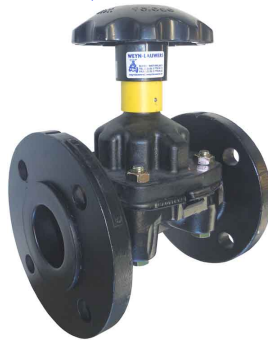
fig 516 membranaafsluiter DN15 tot DN200 huis : gietijzer / standaarduiding membraan : natuurrubber of EPDM temp. : +10°C +90°C (tot +150°C op aanvraag) max. druk 10 bar
