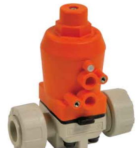
membranaafsluiter pneumatisch 20 mm tot 40 mm lijmeinden fig 515 normaal gesloten temp. : +0°C +80°C max. druk 10 bar huis : PP membraan : PTFE / dichtingen : viton
