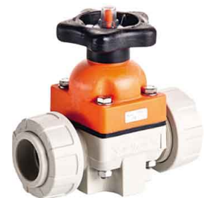
fig 503 membranaafsluiter 20 mm tot 110 mm lijmeinden fig 503bsp membranaafsluiter 1/2" - 4" bsp temp. : +0°C +60°C max. druk 10 bar huis : PVC-U membraan : PTFE / dichtingen : viton
