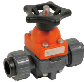
fig 502 membranaafsluiter 20 mm tot 110 mm lijmeinden fig 502bsp membranaafsluiter 1/2" - 4" bsp temp. : +0°C +60°C max. druk 10 bar huis : PVC-U membraan en dichtingen : EPDM
