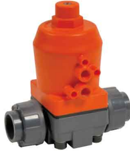
membranaafsluiter pneumatisch 20 mm tot 40 mm lijmeinden fig 511 normaal gesloten fig 513 normaal open temp. : +0°C +60°C max. druk 10 bar huis : PVC-U membraan : PTFE / dichtingen : viton
