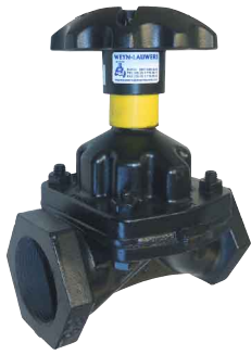
fig 500 membranaafsluiter 1/2" - 2" bsp huis : gietijzer / standaarduiding membraan : natuurrubber of EPDM temp. : +10°C +90°C (tot +150°C op aanvraag) max. druk 10 bar
