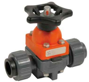
fig 503 membranaafsluiter 20 mm tot 110 mm lijmeinden fig 503bsp membranaafsluiter 1/2" - 4" bsp temp. : +0°C +60°C max. druk 10 bar huis : PVC-U membraan : PTFE / dichtingen : viton
