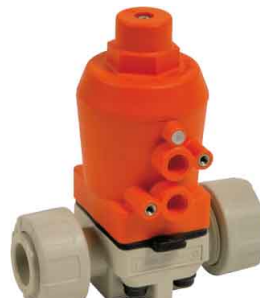
membranaafsluiter pneumatisch 20 mm tot 40 mm lijmeinden fig 514 normaal gesloten temp. : +0°C +80°C max. druk 10 bar huis : PP membraan en dichtingen : EPDM
