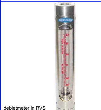
debietmeter in RVS huis en vlotter RVS 316
