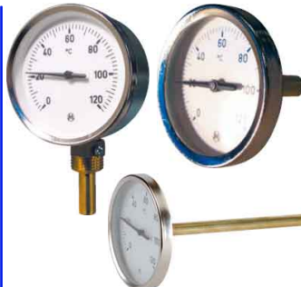
ronde thermometer axiaal (achter) 1/2" fig 559 : kast 63 mm/voeler 45 mm/0+120°C fig 560 : kast 63 mm/voeler 100 mm/0+120°C fig 561 : kast 80 mm/voeler 45 mm/0+120°C fig 562 : kast 80 mm/voeler 100 mm/0+120°C fig 564 : kast 100 mm/voeler 45 mm/0+120°C fig 565 : kast 100 mm/voeler 100 mm/0+120°C
