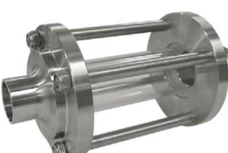
fig 868 RVS kijkglas met laseinden 25 - 38 - 51 - 63 mm huis : RVS 316L glasbuis BW- laseinden max. druk 10 bar max. temp. +140°C
