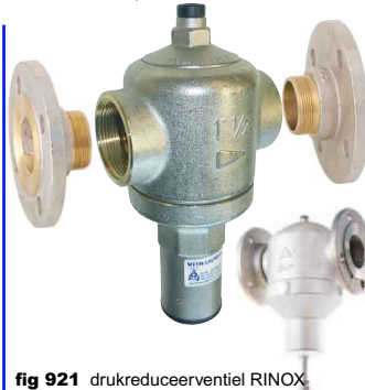
fig 921 drukreduceerventiel RINOX DN25 - DN100 flens PN16 huis : messing vernikkeld / zitting : RVS 304 O-ring : NBR / membraan : EPDM / veer staal temp. : max. +80°C max. voordruk P1 : 25 bar instelbaar tot 1" : 0,8 - 5,5 bar instelbaar >1" : 0,8 - 7,0 bar draadflenzen niet gemonteerd geleverd
