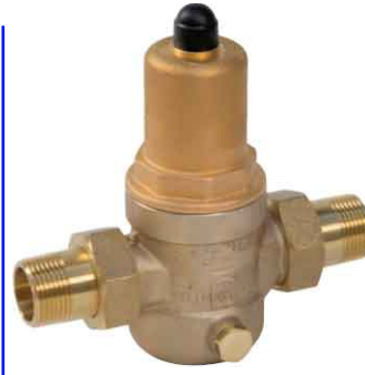
fig 922 bronzen drukreduceerventiel 1/2" - 2" bsp MM met koppelingen huis : brons CC491K voorzien van RVS filterzeef temp. : max. +95°C max. voordruk P1 : 25 bar instelbaar : 1,0 - 7,0 bar geleverd met manometer geschikt voor lucht en niet-corrosieve vloeist.
