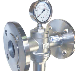
fig 926 RVS drukreduceerventiel PRV DN15 - DN100 flens PN16 huis : RVS 316 (CF8M) voorzien van manometer dichtingen in viton temp. : -15°C +100°C max. druk P1 : 16 bar instelbaar : 1,0 - 6 bar / 4,0 - 10 bar / 8 - 13 bar
