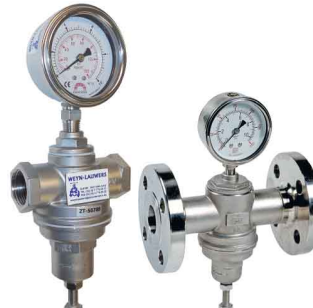
fig 931 RVS stoomdrukreduceerventiel 1/2" - 1" bsp type PRV-S voorzien van manometer diam. 63 mm huis : RVS 316 (CF8M) dichtingen in viton/teflon druk P2 : max. 80 % van druk P1 temp. : max. +192°C / max. druk P1 : 12 bar instelbaar : 1,0 - 6 bar / 4,0 - 10 bar fig 932 idem met flenzen PN16
