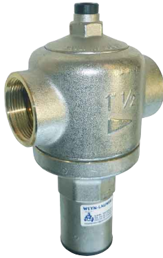
fig 920 drukreduceerventiel RINOX 1/2" - 4" bsp huis : messing vernikkeld / zitting : RVS 304 O-ring : NBR / membraan : EPDM / veer staal temp. : max. +80°C max. voordruk P1 : 25 bar instelbaar tot 1" : 0,8 - 5,5 bar instelbaar >1" : 0,8 - 7,0 bar geschikt voor lucht en niet-corrosieve vloeist.
