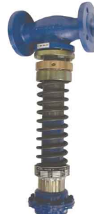
fig 934 stoomdrukreduceerventiel DRP40 DN40 - DN100 flens PN40 huis : staal / balg : RVS temp. : max. +215°C max. druk P1 : 20 bar max. verschildruk delta P : 10 bar instelbaar : 0,2 - 1,5 bar / 1 - 4 bar 1,2 - 6,0 bar / 1 - 10 bar 8,0 - 13 bar
