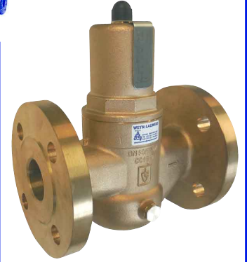
fig 923 bronzen drukreduceerventiel PN16 DN20 - DN80 flens PN16 huis : brons CC491K voorzien van RVS filterzeef temp. : max. +95°C max. voordruk P1 : 25 bar instelbaar : 1,0 - 7,0 bar geschikt voor lucht en niet-corrosieve vloeistoffen
