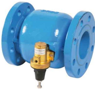
fig 928 drukreduceerventiel BFR PN16 DN50 - DN300 flens huis : gietier met epoxy coating brons/messing binnenwerk voorzien van manometer dichtingen in NBR temp. : -10°C +80°C max. druk P1 : 16 bar instelbaar : 1,0 - 7 bar / 4,0 - 12 bar
