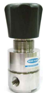
fig 935 RVS drukreduceerventiel PRU PN240 / 3500psi 1/4" - 1/2" npt huis : RVS 316 temp. : -40°C +175°C voorzien van manometers type PRU-100 1/4"npt instelbaar : 0,07-3,4 bar/ 0,2-17 bar/ 0,35-34 bar type PRU-200 1/2"npt instelbaar : 0,2-17 bar / 0,35-34 bar
