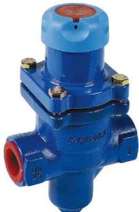
fig 930 stoomdrukreduceerventiel PN25 1/2" - 1" bsp typd BDV25 geschikt voor stoom - lucht - gassen huis : nod. gietijzer GGG40.3 inox binnenwerk ingebouwde filter temp. : max. +210°C max. druk P1 : 17 bar instelbaar : 0,14 - 1,7 / 1,4 - 4,0 / 3,5 - 8,6 bar
