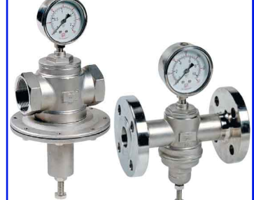
fig 925 RVS drukreduceerventiel LPRV PN10 1/2" - 2" bsp huis : RVS 316 (CF8M) voorzien van manometer dichtingen in viton temp. : -15°C +80°C max. druk P1 : 16 bar instelbaar : 0,2 - 1,5 bar fig 927 idem voorzien van flenzen PN16
