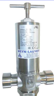
fig 933 RVS drukreduceerventiel 3/8" - 2" bsp huis : RVS 316TI (1.4301 / 1.4571) RVS binnenwerk temp. : -50°C +150°C mogelijk druk : tot 200 bar mogelijk instelbaar : vanaf 0,05 - 200 bar mogelijk beschikbare dichtingen : NBR / FPM / EPDM PTFE / PA6
