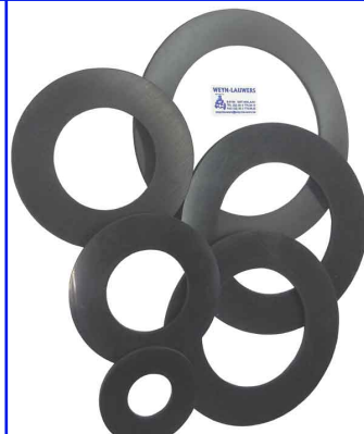
vlakke dichtingen NBR rubber volgens DIN2690 3 mm dik 70° shore SBR temp. : -10°C / +70°C
