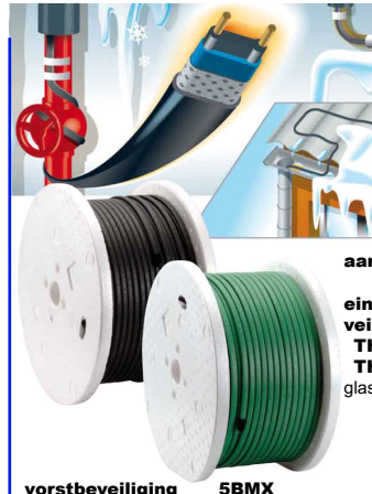
vorstbeveiliging 5BMX zelfregelend verbruik bij 10°C : 12 W/m max. lengte per stroomkring : 150 m
