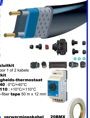
verwarmingkabel 20BMX zelfregelend tot 65°C max. vermogen : 31 W/m max. lengte per stroomkring : 110 m
