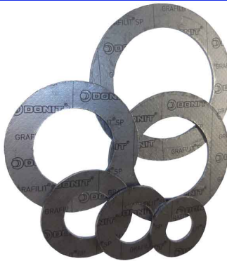
vlakke dichtingen GRAFILIT volgens DIN2690 DN 10 - DN 600 temp. : -200°C / +550°C (pieken tot +700°C)
