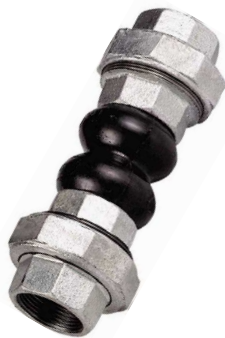
fig 970 rubber compensator PN10 1/2" - 3" bsp 3-delige galva koppelingen balg : EPDM rubber temp. : -10°C/+110°C lengte : 200 mm tot 2" / 240 mm > 2"
