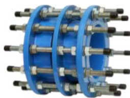
fig 980 uitbouwstuk PN 10 DN 80 - DN 1400 huis : nodulair gietijzer, met epoxy coating stalen stangen en moeren flenzen geboord volgens PN 10 temp. : 0°C/+90°C fig 981 uitbouwstuk PN 16
