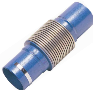
fig 976 inox compensator PN16 BW laseinden DN25 - DN250 stalen laseinden inox 321 balg en inwendige liner temp. : -20°C/+300°C
