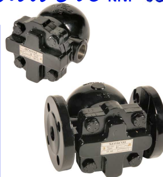
fig SK70 stalen vlotter-condenspot PN25 1/2" - 1" bsp / DN15 - DN25 flens huis : staal A216WCB inox vlotter en binnenwerk temp. : max. +400°C ingebouwde thermostatische ontluchter delta P : 4,5 bar / 10 bar / 14 bar horizontale montage
