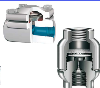
thermostatische condenspot fig TKK21 staal / PN25 1/2" bsp huis : staal A105 inox binnenwerk voorzien van ingebouwde filterzeef max. druk P1 : 21 bar / temp. : max. +250°C fig TKK42 inox / PN40 1/4" - 1" bsp max. druk P1 : 32 bar / temp. : max. +240°C max. verschildruk delta P : 22 bar
