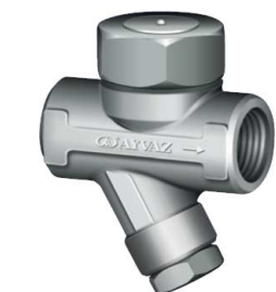
fig TDK71 thermodynamische condenspot PN63 1/2" - 1" bsp huis : inox A743 inox binnenwerk voorzien van Y-filter druk P2 : max. 80 % van druk P1 temp. : max. +400°C max. druk P1 : 42 bar horizontale montage
