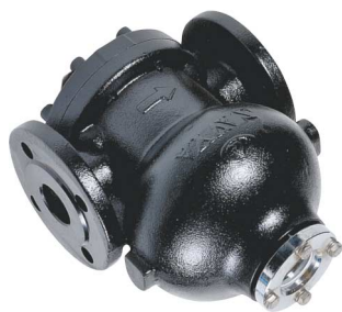
fig SK55 vlotter-condenspot PN16 DN32 - DN50 flens huis : nodulair gietijzer GGG40.3 inox vlotter en binnenwerk temp. : max. +250°C voorzien van borosilicaat kijkglas ingebouwde thermostatische ontluchter delta P : 4,5 bar / 10 bar / 14 bar horizontale montage
