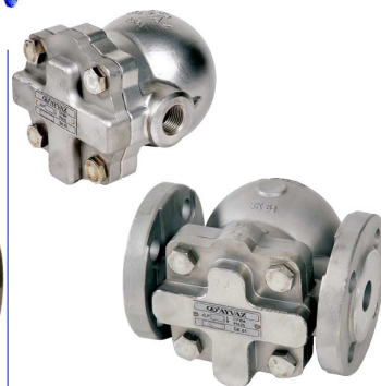
fig SK70 inox vlotter-condenspot PN25 1/2" - 1" bsp / DN15 - DN25 flens huis : inox 316 (CF8M) inox vlotter en binnenwerk temp. : max. +250°C ingebouwde thermostatische ontluchter delta P : 4,5 bar / 10 bar / 14 bar horizontale montage
