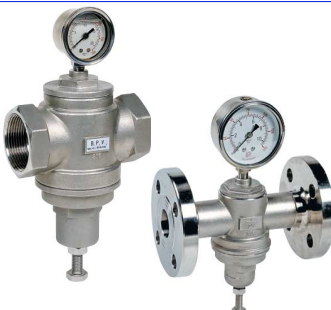
fig 931 inox drukreducerendventiel 1/2" - 1" bsp type PRV-S voorzien van manometer diam. 63 mm huis : inox 316 (CF8M) dichtingen in viton/teflon druk P2 : max. 80 % van druk P1 temp. : max. +192°C / max. druk P1 : 12 bar instelbaar : 1,0 - 6 bar / 4,0 - 10 bar fig 932 idem met flenzen PN16
