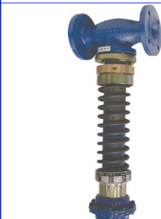
fig 934 drukreducerendventiel DRP40 DN40 - DN100 flens PN40 huis : staal / balg : inox temp. : max. +215°C max. druk P1 : 20 bar max. verschildruk delta P : 10 bar instelbaar : 0,2 - 1,5 bar / 1 - 4 bar 1,2 - 6,0 bar / 1 - 10 bar 8,0 - 13 bar
