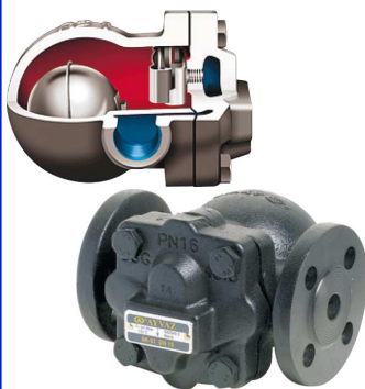
fig SK51 vlotter-condenspot PN16 1/2" - 1" bsp / DN15 - DN25 flens huis : nodulair gietijzer GGG40.3 inox vlotter en binnenwerk temp. : max. +250°C ingebouwde thermostatische ontluchter delta P : 4,5 bar / 10 bar / 14 bar horizontale montage
