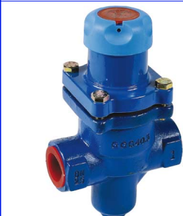
fig 930 drukreducerendventiel PN25 1/2" - 1" bsp type BDV25 geschikt voor stoom - lucht - gas huis : nod. gietijzer GGG40.3 inox binnenwerk ingebouwde filter temp. : max. +210°C max. druk P1 : 17 bar instelbaar : 0,14 - 1,7 / 1,4 - 4,0 / 3,5 - 8,6 bar
