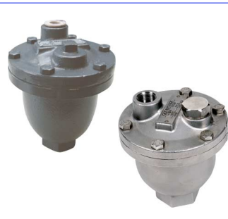
ontluchters 3/4" bsp fig PF20 : huis in gietijzer max. druk : 10 bar temp. : max. +120°C fig AV02 : huis in inox max. druk : 12 bar temp. : max. +200°C
