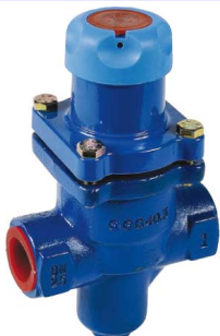
fig 930 stoomdrukreducerventiel PN25 1/2" - 1" bsp typd BDV25 geschikt voor stoom - lucht - gassen huis : nod. gietijzer GGG40.3 inox binnenwerk ingebouwde filter temp. : max. +210°C max. druk P1 : 17 bar instelbaar : 0,14 - 1,7 / 1,4 - 4,0 / 3,5 - 8,6 bar
