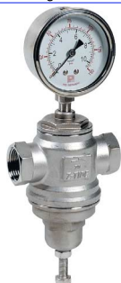
fig 924 inox drukreducerventiel PRV PN16 1/2" - 2" bsp huis : inox 316 (CF8M) voorzien van manometer dichtingen in viton temp. : -15°C +100°C max. druk P1 : 16 bar instelbaar : 1,0- 6 bar / 4,0- 10 bar / 8- 13 bar
