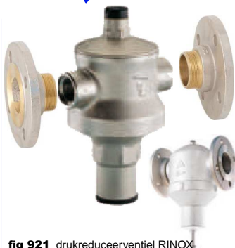
fig 921 drukreducerventiel RINOX DN25 - DN100 flens PN16 huis : messing vernikkeld / zitting : inox 304 O-ring : NBR / membraan : EPDM / veer staal temp. : max. +80°C max. voordruk P1 : 25 bar instelbereik tot 1" : 0,8 - 5,5 bar instelbereik >1" : 0,8 - 7,0 bar draadflenzen niet gemonteerd geleverd
