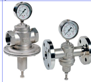
fig 925 inox drukreducerventiel LPRV PN10 1/2" - 2" bsp huis : inox 316 (CF8M) voorzien van manometer dichtingen in viton temp. : -15°C +80°C max. druk P1 : 16 bar instelbaar : 0,2- 1,5 bar fig 927 idem voorzien van flenzen PN16
