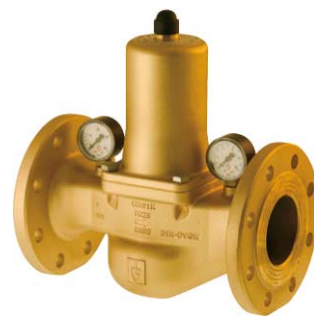
fig 923 bronzen drukreducerventiel PN16 DN20 - DN80 flens PN16 huis : brons CC491K voorzien van inox filterzeef temp. : max. +95°C max. voordruk P1 : 25 bar instelbereik : 1,0 - 7,0 bar geleverd met manometer geschikt voor lucht en niet-corrosieve vloeist.
