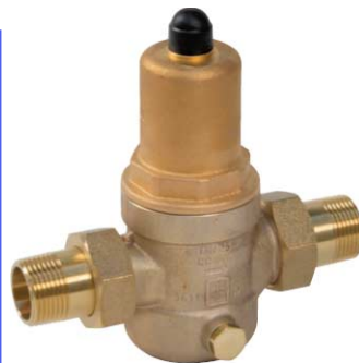
fig 922 bronzen drukreducerventiel 1/2" - 2" bsp MM met koppelingen huis : brons CC491K voorzien van inox filterzeef temp. : max. +95°C max. voordruk P1 : 25 bar instelbereik : 1,0 - 7,0 bar geleverd met manometer geschikt voor lucht en niet-corrosieve vloeist.
