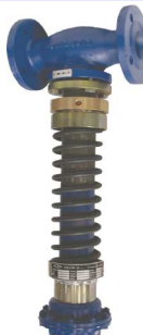
fig 934 stoomdrukreducerventiel DRP40 DN40 - DN100 flens PN40 huis : staal / balg : inox temp. : max. +215°C max. druk P1 : 20 bar max. verschildruk delta P : 10 bar instelbaar : 0,2 - 1,5 bar / 1 - 4 bar 1,2 - 6,0 bar / 1 - 10 bar 8,0 - 13 bar
