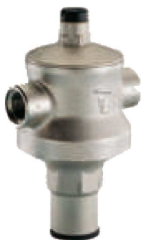
fig 920 drukreducerventiel RINOX 1/2" - 4" bsp huis : messing vernikkeld / zitting : inox 304 O-ring : NBR / membraan : EPDM / veer staal temp. : max. +80°C max. voordruk P1 : 25 bar instelbereik tot 1" : 0,8 - 5,5 bar instelbereik >1" : 0,8 - 7,0 bar geschikt voor lucht en niet-corrosieve vloeist.
