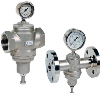
fig 931 inox stoomdrukreducerventiel 1/2" - 1" bsp type PRV-S voorzien van manometer diam. 63 mm huis : inox 316 (CF8M) dichtingen in viton/teflon druk P2 : max. 80 % van druk P1 temp. : max. +192°C / max. druk P1 : 12 bar instelbaar : 1,0 - 6 bar / 4,0 - 10 bar fig 932 idem met flenzen PN16
