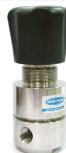
fig 935 inox drukreducerventiel PRU PN240 / 3500psi 1/4" - 1/2" npt huis : inox 316 temp. : -40°C +175°C voorzien van manometers type PRU-100 1/4"npt instelbaar : 0,07-3,4 bar/ 0,2-17 bar/ 0,35-34 bar type PRU-200 1/2"npt instelbaar : 0,2-17 bar / 0,35-34 bar
