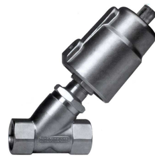
fig 5311I klepafsluiter inox pn16 pneumatisch enkelwerkend normaal gesloten 1/2" - 2" bsp huis en pneumaat : inox 316 PTFE klepafdichting stuurdruk pneumaat : 3 - 10 bar temp. : -25°C/+180°C meestroomsluitende pneumaat fig 5311I NPT : 1/2" - 2" npt
