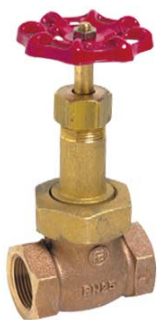
fig 411 klepafsluiter brons PN25 1/4" - 2" bsp huis : brons inox 316 klepafdichting grafiet spindelafdichting
