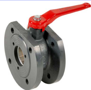
gietijzer PN16 volle doorlaat fig 181.0 : DN40-DN100 verchroomde messing bal PTFE dichtingen temp. : -10°C/+150°C
