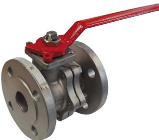
inox 300 lbs volle doorlaat fig 196 : 1/2" - 6" inox CF8M bal PTFE TFM1600 dichtingen temp. : -50°C/+250°C voorzien van iso 5211 topflens inbouwlengte volgens ASME B16.10
