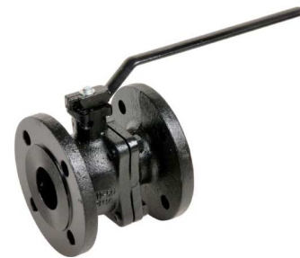
gietijzer PN16 volle doorlaat fig 148 : DN15-DN200 inox bol PTFE dichtingen temp. : -10°C/+180°C tot DN100 : F4 inbouwlengte > DN100 : F5 inbouwlengte
