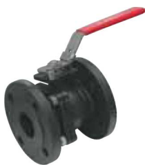
staal 150 lbs volle doorlaat fig 193 : 1/2" - 8" vergrendelbare hendel inox bol / PTFE dichtingen temp. : -40°C/+180°C voorzien van iso 5211 topflens inbouwlengte volgens ASME B16.10
