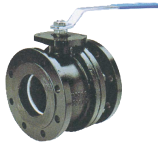
nodulair gietijzer PN16 volle doorlaat fig 151 : DN15-DN200 inox 304 bal en spindel PTFE + 15 % GF dichtingen temp. : -30°C/+180°C voorzien van iso 5211 topflens inbouwlengte volgens DIN 3202 F4
