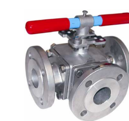
inox PN16 volle doorlaat L- of T-boring fig 192 : DN15-DN150 inox 316 bal en spindel 4 PTFE versterkte dichtingen temp. : -30°C/+180°C voorzien van iso 5211 topflens voor rechtstreekse montage
