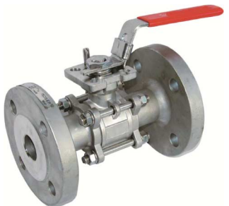
inox PN40 volle doorlaat PTFE + 15 % GF dichtingen fig 176 : DN15-DN100 inbouwlengte volgens DIN 3202 F1 temp. : -30°C/+200°C voorzien van iso 5211 topflens voor rechtstreekse montage
