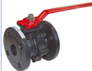
staal 300 lbs volle doorlaat fig 194 : 1/2" - 6" inox CF8M bol PTFE TFM1600 dichtingen temp. : -29°C/+250°C voorzien van iso 5211 topflens inbouwlengte volgens ASME B16.10
