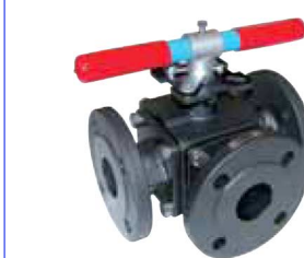
staal PN16 volle doorlaat L- of T-boring fig 191 : DN50-DN150 inox 316 bol en spindel 4 PTFE versterkte dichtingen temp. : -30°C/+180°C voorzien van iso 5211 topflens voor rechtstreekse montage
