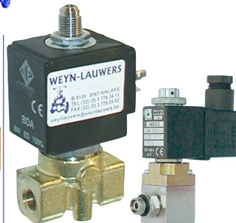
3-weg magneetventiel directwerkend = geen verschilddruk nodig fig 600 : FF 1/8" - 1/4" bsp huis : messing viton dichting temp. : -10°C +140°C 24 - 48 - 230 VAC / 12 - 24 VDC fig 601 : MF 1/8" bsp
