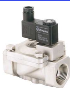
2-weg magneetventiel normaal gesloten minimum verschilddruk nodig : 0,5 bar fig 629 : (SPU225) FF 3/8" - 2" bsp huis : inox / viton dichting temp. : -10°C +90°C 24 - 48 - 230 VAC / 12 - 24 VDC fig 630 : (SPU225-X) FF 1/2" - 3/4" bsp Ex-uitvoering ATEX EEx m II 2G/D T4 voor zones 1, 21, 2 en 22
