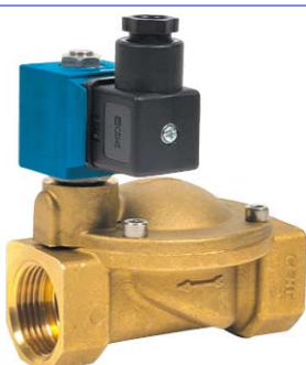
2-weg magneetventiel normaal gesloten minimum verschilddruk nodig : 0,3 bar fig 621 : (ESM86) FF 3/8" - 3" bsp huis : messing NBR dichting temp. : -10°C +80°C 24 - 48 - 230 VAC / 12 - 24 VDC fig 622 : normaal open(ESM87) FF3/8"-3"bsp
