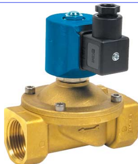
2-weg magneetventiel normaal gesloten directwerkend = geen verschilddruk nodig fig 623 : (VSO84) FF 3/8" - 2" bsp huis : messing NBR dichting temp. : -10°C +80°C 24 - 48 - 230 VAC / 12 - 24 VDC
