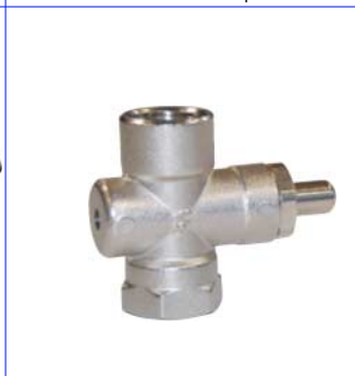
manometerkraan PN4 met drukknop en veer fig 698 : 1/4FF of 1/2"FF bps huis in messing vernikkeld max. temp. : +120°C
