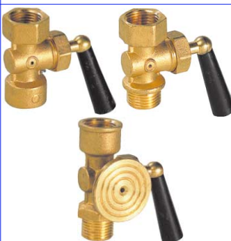
manometerkraan PN16 huis in messing max. temp. : +120°C fig 690 : 1/2" FF bsp fig 691 : 1/2" MF bsp fig 696 : 1/2" MF bsp met proefflens
