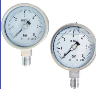
manometer diam. 100 mm klasse 1,0 vacuüm : -1 +1 bar druk : 0 - 1,6/2,5/4/6/10/16/25/40/60 bar fig 673 : droge uitvoering fig 671 : glycerine gevuld aansluiting / bourdon in inox 316 kast inox 304 1/2" bsp radiaal aansluiting (onder)
