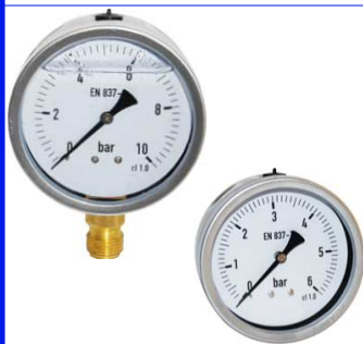
manometer diam. 100 mm klasse 1,0 vacuüm : -1 +1 bar druk : 0 - 1,6/2,5/4/6/10/16/25/40/60 bar glycerine gevuld aansluiting en binnenwerk in messing kast inox 304 fig 669 : 1/2" bsp radiaal (onder) fig 670 : 1/2" bsp axiaal (achter)
