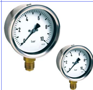
droge manometers klasse 1,6 druk : 0 - 1/2,5/4/6/10/16/25 bar aansluiting en binnenwerk in messing kast inox 304 fig 667 : 1/2" bsp radiaal (onder) diam. 100 mm fig 657 : 1/4" bsp radiaal (onder) diam. 63 mm
