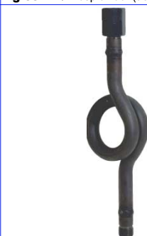
sifonpijp voor hoge druk voorzien van wartel volgens din 16282 type C max. temp. : +300°C bij 80 bar aansluiting 1/2" MF bsp fig 678 : stalen uitvoering fig 679 : inox uitvoering
