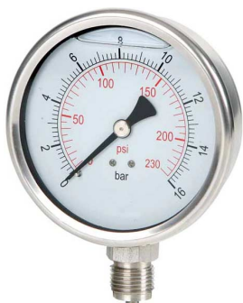
manometer diam. 100 mm klasse 1,6 fig 672 : 0 - 2,5/4/6/10/16/25/40/60/100 bar dubbele schaal in psi glycerine gevuld kast inox 304 aansluiting / bourdon in inox 316 1/2" bsp radiaal aansluiting (onder)
