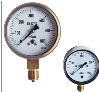
manometers in mbar druk : 0 - 60/100/250/400/600 mbar droge uitvoering aansluiting en binnenwerk in messing kast inox 304 fig 668 : klasse 1,0 / 1/2" bsp radiaal (onder) diam. 100 mm fig 658 : klasse 1,0 / 1/4" bsp radiaal (onder) diam. 63 mm
