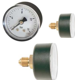
manometer met ABS kunststof kast klasse 2,5 plexiglas scherm - droge uitvoering druk : 0 - 1,0/2,5/4/6/10/16/25 bar aansluiting en binnenwerk in messing fig 656 : diam. 63 mm - 1/4" bsp axiaal fig 652 : diam. 50 mm - 1/4" bsp axiaal fig 650 : diam. 40 mm - 1/8" bsp axiaal
