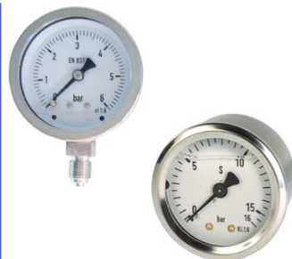
manometer diam. 63 mm klasse 1,6 vacuüm : -1 +1 bar druk : 0 - 1,6/2,5/4/6/10/16/25/40/60 bar fig 662 : droge uitvoering 1/4" bsp radiaal fig 663 : glycerine gevuld 1/4" bsp radiaal aansluiting / bourdon in inox 316 kast inox 304
