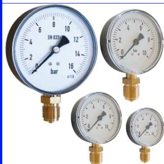
manometer met ABS kunststof kast klasse 1,6 plexiglas scherm - droge uitvoering druk : 0 - 1,0/2,5/4/6/10/16/25/40 bar aansluiting en binnenwerk in messing fig 665 : diam. 100 mm - 1/2" bsp radiaal fig 664 : diam. 80 mm - 1/2" bsp radiaal fig 655 : diam. 63 mm - 1/4" bsp radiaal fig 651 : diam. 50 mm - 1/4" bsp radiaal
