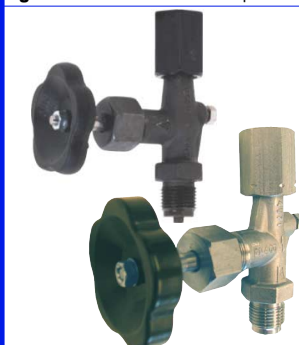
manometerkraan hoge druk PN400 voorzien van wartel volgens din 16282 type C max. temp. : +200°C aansluiting 1/2" MF bsp fig 693 : stalen uitvoering fig 694 : inox uitvoering
