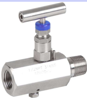
fig 525 naaldventiel inox PN420 MF 1/4" en 1/2" bsp ANSI 6000 lbs huis : inox 316 teflon spindelafdichting voorzien van aflaatoepening temp. : -54°C/+250°C geschikt als manometerkraan
