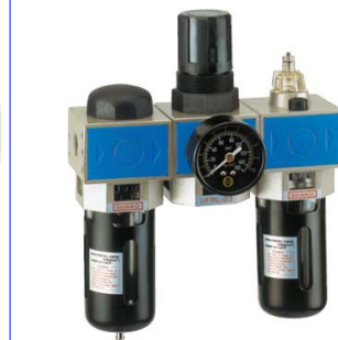
perslucht apparaat - combinaties fig 546 filter/olienevelaar/drukregelaar met manometer filter 40 micron 1/4" - 1" bsp temp. : 0°C/+50°C aluminium huis klokken in polycarbonaat / bescherming in glasvezel/nylon
