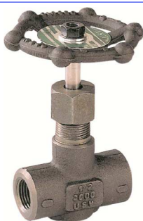
naaldventiel staal PN210 A105/F6 smeedstaal 1/4" - 1" ANSI 3000 lbs grafiet spindelafdichting / naald : inox 316 temp. : -20°C/+250°C fig 526 bsp draadaansluiting fig 527 npt draadaansluiting fig 528 SW laseinden
