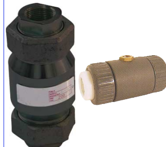
fig 687 mofafsluiter PVC 3/4" - 2" bsp huis en aansluiting PVC mof : natuurrubber max. werkdruk 5 bar stuurdruk : = werkdruk + 1,5 bar temp. : -30°C +60°C 1/4" bsp persluchtaansluiting
