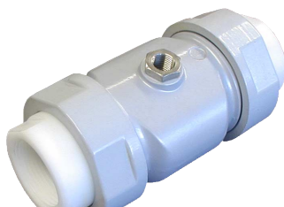
fig 685 mofafsluiter aluminium 1/2" - 2" bsp huis : aluminium / aansluitingen : POM mof : natuurrubber max. werkdruk 6 bar stuurdruk : = werkdruk + 2 bar temp. : max. +80°C voedingsgeschikte rubber op aanvraag
