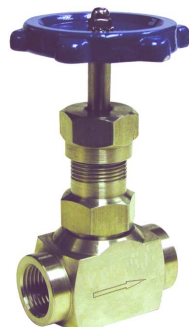
fig 521 naaldventiel staal PN210 1/4" - 1" bsp ANSI 3000 lbs huis : staal A105 teflon spindelafdichting naald : inox 316 temp. : -20°C/+250°C
