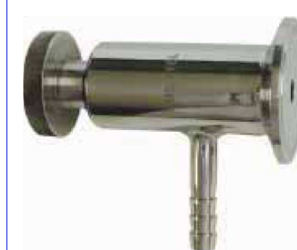
fig 296 terugslagklep RVS304 las/las 1" - 4" las/draad volgens DIN 11851 huis : inox 304 dichtingsring SILICONE max. druk : 10 bar max. temp. : +95°C gepolierde uitvoering
