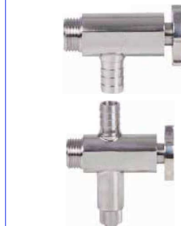
fig 888 peilglaskraan boven RVS304 fig 889 peilglaskraan onder met aflaat 1/2" bsp - slangpilaar 14 mm huis : inox 304 dichting PTFE max. druk 10 bar
