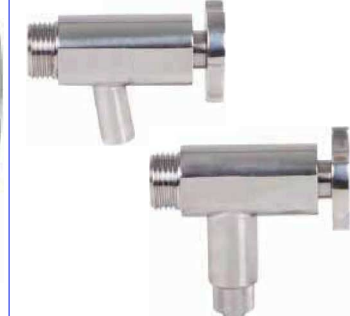
fig 297 staalnamekraan RVS304 1/2" bsp huis : inox 304 dichting PTFE max. druk 10 bar
