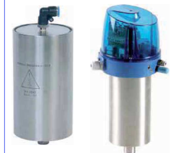
fig 277 dubbelwerkende pneumaat fig 278 enkelwerkende pneumaat huis : inox 304 werkdruk 5 bar fig 279 bedieningsbox mogelijkheden : - 1 of 2 eind-kontakten - voorzien van 1 of 2 stuurventielen
