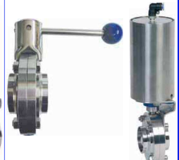
fig 283 vlinderklep RVS304 las/las 1" - 4" las/las huis : inox 304 dichting EPDM (andere op aanvraag) max. druk : 10 bar / max. temp. : +120°C fig 290 dubbelwerkend pneumatisch fig 291 enkelwerkend pneumatisch
