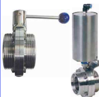
fig 281 vlinderklep RVS304 draad/draad 1" - 4" draad/draad volgens DIN 11851 huis : inox 304 dichting EPDM (andere op aanvraag) max. druk : 10 bar / max. temp. : +120°C fig 286 dubbelwerkend pneumatisch fig 287 enkelwerkend pneumatisch
