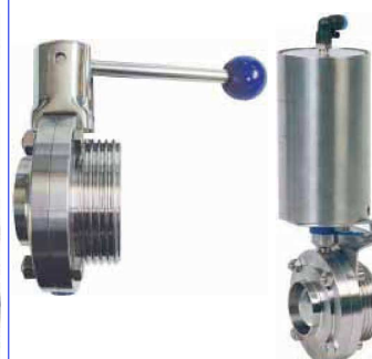
fig 282 vlinderklep RVS304 las/draad 1" - 4" las/draad volgens DIN 11851 huis : inox 304 dichting EPDM (andere op aanvraag) max. druk : 10 bar / max. temp. : +120°C fig 288 dubbelwerkend pneumatisch fig 289 enkelwerkend pneumatisch
