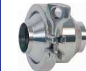
fig 281 vlinderklep RVS304 draad/draad 1" - 4" draad/draad volgens DIN 11851 huis : inox 304 dichting EPDM (andere op aanvraag) max. druk : 10 bar / max. temp. : +120°C fig 286 dubbelwerkend pneumatisch fig 287 enkelwerkend pneumatisch
