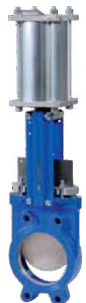
fig 381 plaatafsluiter / flenzen PN10 huis gietijzer + rilsan coating plaat en spindel RVS304 1-zijdig dichtend DN50 - DN800 NBR dichting : temp. : -10°C/+80°C voorzien van dubbelwerkende pneumaat fig 381M : metaaldichtend
