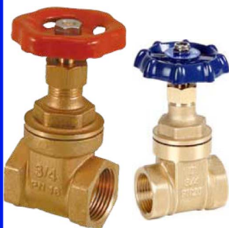
fig 300 schuifafsluiter messing max. druk 16 bar tot 2", 10 bar boven 2" temp. : -10°C/+110°C 1/4"- 4" bsp niet-stijgende spindel en handwiel fig 301 : PN20 1/2" - 4" bsp fig 300NPT : 3/8" - 4" npt schroefdraad fig 301NPT : PN20 1/2" - 4" npt
