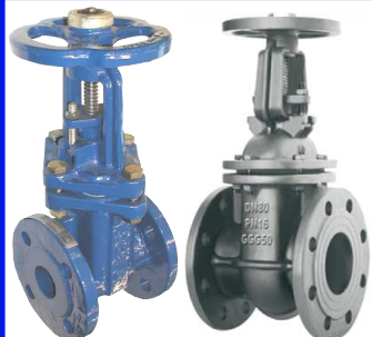
fig 340 schuifafsluiter PN10 huis gietijzer GG25 - GJL-250 inox afdichtingsring / inox spindel max. druk 10 bar tot dn150 / 6 bar hoger DN40 - DN400 temp. : -10°C/+120°C inbouw lengte DIN 3202 F4 niet-stijgend handwiel en stijgende spindel fig 342 : huis in nodulair gietijzer GGG50
