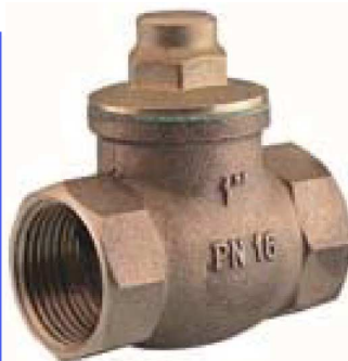
bronzen terugslagklep PN16 met inox veer teflon klepafdichtingsring temp. : -10°C +200°C fig 716 : FF 3/8" - 2" bsp
