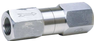
inox terugslagklep PN16 met flapper / zonder veer fig 712 : FF 1/2" - 2" bsp teflon klepring temp. : -30°C +180°C max. 16 bar bij 120°C max. 10 bar bij 180°C fig 712NPT : met NPT draad
