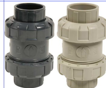
PVC / PP veerterugslagkleppen PN10 PVC uitvoering : max. +60°C / PP max. +80°C fig 730 : PVC/EPDM dichtingen / 1/2"-2" bsp fig 731 : PVC/EPDM dichtingen / 20-63 lijmm fig 733 : PVC/VITON dichtingen / 1/2"-2" bsp fig 734 : PVC/VITON dichtingen / 20-63 lijmm fig 740 : PP/EPDM dichtingen / 1/2"-2" bsp fig 741 : PP/EPDM dichtingen / 20-63 lijmm fig 743 : PP/VITON dichtingen / 1/2"-2" bsp fig 744 : PP/VITON dichtingen / 20-63 lijmm
