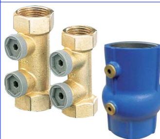
BELGAQUA gekeurde terugslagklep PN10 EA keerkleppen pollustop : FF 1/2" - 2" bsp in messing FF 2 1/2" - 3" bsp in gietijzer messing : temp. : max +80°C gietijzer : temp. : max +100°C 2 afgeplugde boringen veer in inox
