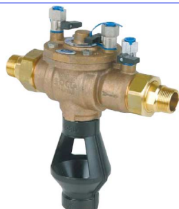
BELGAQUA gekeurde terugslagklep PN10 BA terugstroombeveiliging MM 1/2" - 2" bsp huis messing ontlastklep : polymer PA kleppen : polymer POM temp. : max. +65°C
