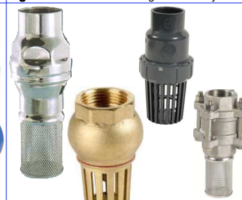
voetkleppen met filterzeef fig 791 : messing/NBR : FF 1/2" - 4" bsp temp. : 0°C +90°C fig 792 : inox/inox : FF 3/8" - 4" bsp veer 3-delig huis / temp. : -30°C +200°C fig 793 : inox/viton : FF 1/2" - 4" bsp veer temp. : -25°C +150°C fig 732 : PVC/EPDM : 20-63 mm lijmeinden veer temp. : 0°C +60°C
