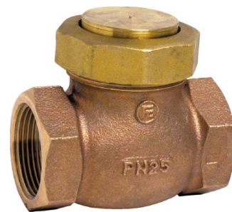
bronzen terugslagklep PN25 met inox veer inox klep en klepzitting temp. : -10°C +200°C fig 717 : FF 1/4" - 2" bsp
