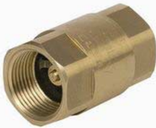
messing terugslagklep PN25/12 met veer fig 704 : FF 3/8" - 4" bsp NBR rubber afdichting temp. : -10°C +90°C inox veer fig 704NPT : met NPT schroefdraad fig 704CHROOM : verchroomd
