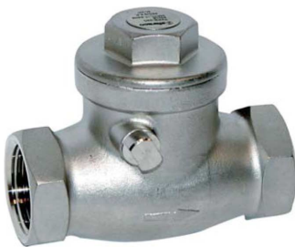
messing terugslagklep PN10 met flapper / zonder veer fig 711 : FF 3/8" - 4" bsp rubber beklede klep 3/8" - 2" : met EPDM rubber / -10°C +90°C 2 1/2" - 4" : met NBR rubber / -10°C +80°C fig 710 : FF 3/8"-4" bsp metaal/metaal dichtend fig 710NPT / fig 711NPT : met NPT draad
