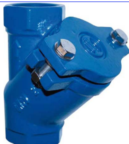
nodulair gietijzeren balkeerplep PN10 huis : GGG40 fig 770 FF 1" - 3" bsp bal NBR rubber tot 6/4" bal aluminium met NBR coating > 6/4" temp. : -30°C +180°C
