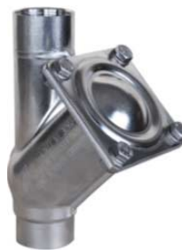
inox balkeerplep PN16 huis inox 316 fig 773 : FF 5/4" - 2" bsp bal aluminium met viton coating temp. : -30°C +180°C fig 774 : FF 5/4" - 2" bsp bal aluminium met NBR coating temp. : -30°C +90°C
