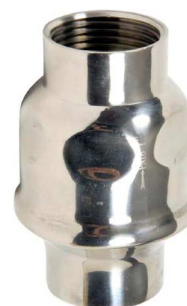
inox terugslagklep PN16 met inox veer inox klep en viton klepzitting temp. : -10°C +150°C FF 1/4" - 4" bsp fig 713 : in inox 304 fig 714 : in inox 316
