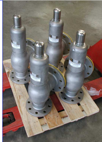
fig 905 inox veiligheidsklep 3/8" - 2" bsp MM huis : inox 316 teflon zitting temp. : -10°C/+200°C insteldruk : 0,5 - 12 bar (elke 0,5 bar)
