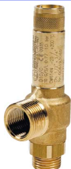
fig 903 messing veiligheidsklep 1/4" - 2" bsp MM huis : messing CW614N viton zitting temp. : -20°C/+160°C insteldruk : 0,5 - 12 bar (elke 0,5 bar) bijzonder geschikt voor vloeistoffen
