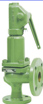
fig 1402 geflensd veiligheidsventiel PN40 DN20 tot DN150 huis : nod.gietijzer GGG40 / met kleplicher gesloten kap / inox zitting temp. : -10°C +350°C min. afsteldruk 0,5 bar bureau veritas marine/offshore gekeurd
