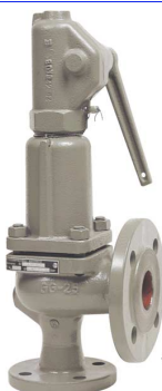
fig 1401 geflensd veiligheidsventiel PN16 DN20 tot DN150 huis : gietijzer GG20 / met kleplicher gesloten kap / inox zitting temp. : -10°C +200°C min. afsteldruk 0,5 bar bureau veritas marine/offshore gekeurd
