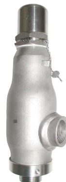
fig 1216 inox veiligheidsklep 1/2" tot 2" bsp of npt huis : inox A351 CF3M / gesloten kap viton- / teflon- of metaaldichtende zitting druk : PN40 tot PN400 fig 1216C : met clamp-aansluiting fig 1216B : flenzen PN10/40 ansi 150/300 lbs
