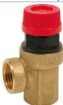
fig 910 messing veiligheidsklep 1/2" - 3/4" bsp vooringesteld op : 2,5 / 3 / 4 / 6 / 7 / 8 / 10 bar centrale verwarming en sanitair
