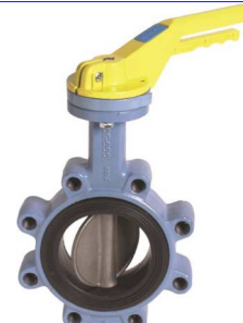
fig 265B gas lug type PN10/16 huis nodulair gietijzer + epoxy coating vlinder nodulair gietijzer dichting NBR DN40 - DN200 temp. : -20°C/+80°C voorzien van iso 5211 topflens
