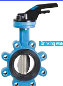
fig 265 lug type PN10/16 huis nodulair gietijzer + epoxy coating vlinder en as RVS316 dichting EPDM DN40 - DN400 temp. : -20°C/+120°C voorzien van iso 5211 topflens wormwielkast op aanvraag verwisselbare dichting
