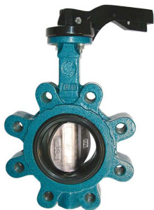
fig 260 lug type PN10/16 huis gietijzer + epoxy coating vlinder en as RVS316 dichting EPDM DN40 - DN300 temp. : -20°C/+120°C voorzien van iso 5211 topflens wormwielkast op aanvraag ge Vulcaniseerde dichting
