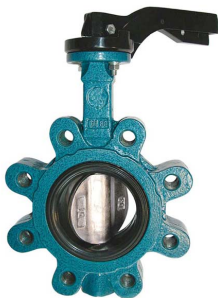
fig 250 lug type PN10/16 huis gietijzer + epoxy coating vlinder nodulair gietijzer vernikkeld dichting EPDM DN40 - DN300 temp. : -20°C/+120°C voorzien van iso 5211 topflens wormwielkast op aanvraag ge Vulcaniseerde dichting
