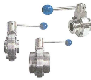
sanitaire vlinderkleppen huis en vlinder inox dichting EPDM aansluitingen 1" - 4" : las/las draad/draad DIN 11851 las/draad DIN 11851 clamp/clamp
