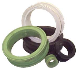
zittingen voor fig 215/265 EPDM : -20°C/+120°C (pieken tot 130°C) NBR : -20°C/+80°C VITON : -10°C/+180°C SILICONE : -30°C/+190°C
