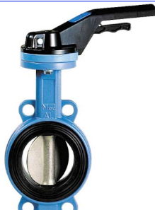
fig 215 wafer type PN10/16 ansi 150 lbs huis nodulair gietijzer + epoxy coating vlinder en as RVS316 dichting EPDM DN32 - DN600 temp. : -20°C/+120°C voorzien van iso 5211 topflens wormwielkast op aanvraag verwisselbare dichting
