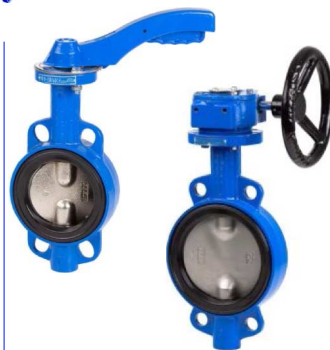
fig 200 wafer type PN10/16 ansi 150 lbs huis gietijzer + epoxy coating vlinder nodulair gietijzer vernikkeld vlinder en as RVS316 DN50 - DN500 temp. : -20°C/+120°C voorzien van iso 5211 topflens wormwielkast vanaf DN300
