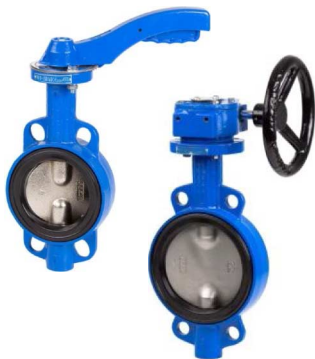
fig 210G wafer type PN10/16 ansi 150 lbs huis gietijzer + epoxy coating vlinder en as RVS316 dichting EPDM DN50 - DN500 temp. : -20°C/+120°C voorzien van iso 5211 topflens wormwielkast vanaf DN300 verwisselbare dichting
