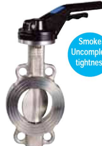
fig 231/233 wafer type PN10/16 ansi 150 lbs voor rookgassen tot 350°C sluit niet 100% af vlinder en as RVS316 DN32 - DN200 fig 231 : huis RVS316 fig 233 : huis staal A213WCB voorzien van iso 5211 topflens
