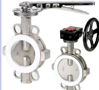
fig 230 wafer type PN10/16 ansi 150 lbs huis RVS316 vlinder en as RVS316 dichting PTFE op EPDM basising DN50 - DN200 temp. : -25°C/+180°C voorzien van iso 5211 topflens wormwielkast vanaf DN150 inbouw lengte volgens DIN 3202 K1
