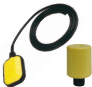
fig 950 horizontale vlotterafsluiter voorzien van 3 m kabel schakelt 230V-50Hz met een maximaal vermogen van 1,5 kW IP68 temp. : max +50°C
