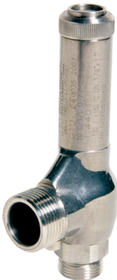
fig 905 inox veiligheidsklep 3/8" - 2" bsp MM huis : inox 316 teflon zitting temp. : -10°C/+200°C insteldruk : 0,5 - 12 bar (elke 0,5 bar)
