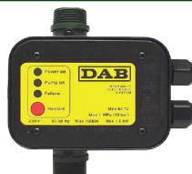
De presscontrol is een elektronisch toestel voor de aansturing en beveiliging van huishoudelijke pompen zonder membraanvat. Door de ingebouwde debietmeting en drukmeting kan de Presscontrol de pomp laten starten, stoppen en bij watergebrek in storing laten gaan. Eenvoudig te installeren op de pomp.
